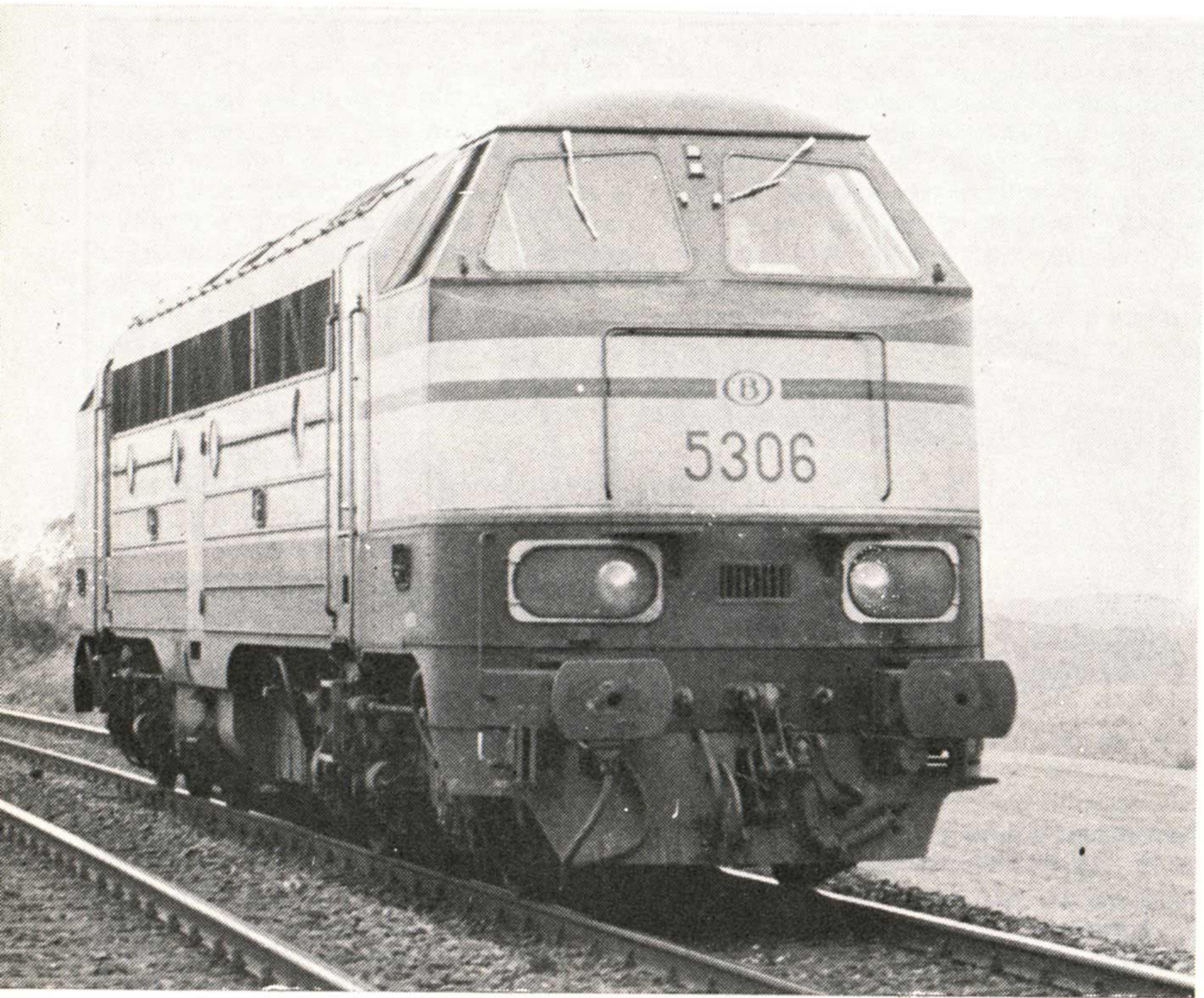
Ces deux photos montrent la locomotive n° 5306 après et avant la transformation des cabines de conduite et des avant-corps. Photos Y. Steenebruggen.
