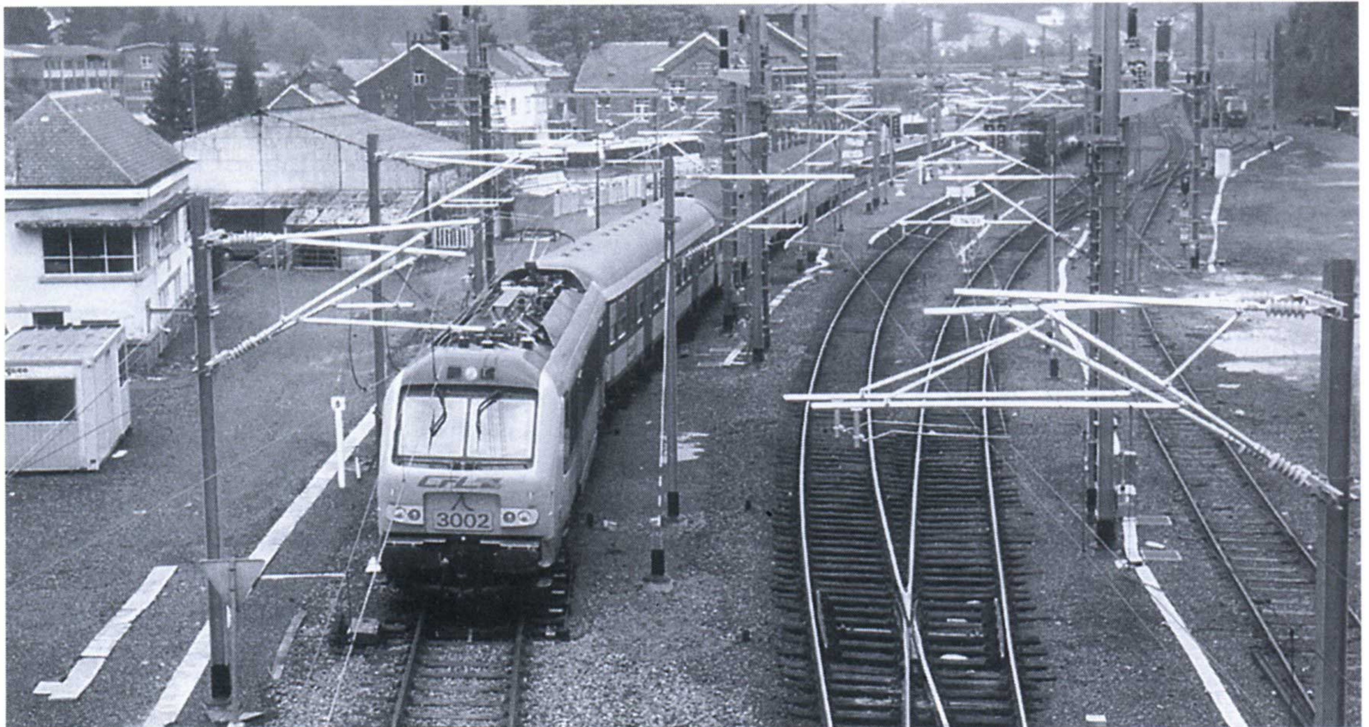
Une locomotive polycourant de la série 3000 des CFL en gare de Trois-Ponts, sous la nouvelle caténaire 25 kV.
