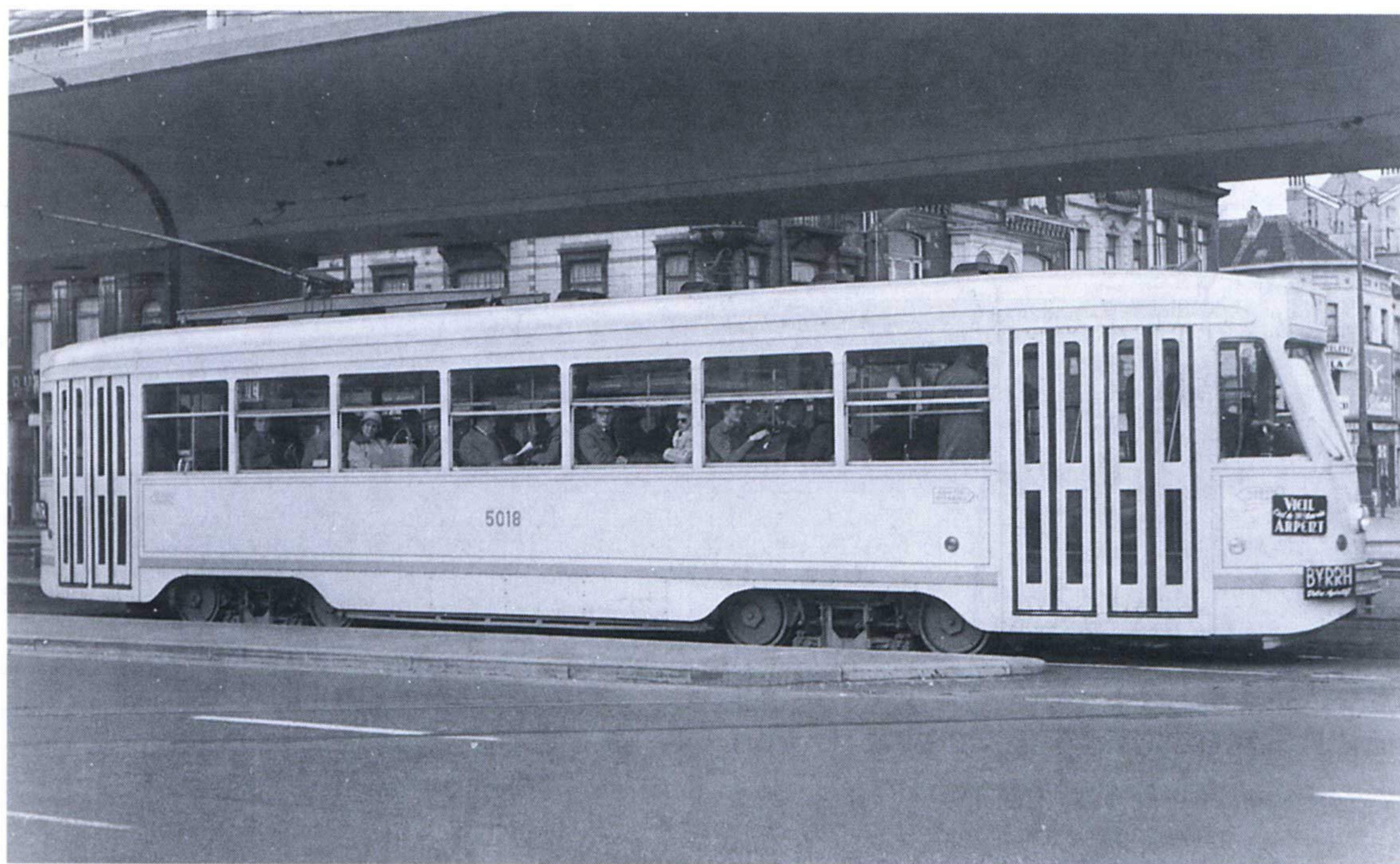
Avril 1960 : la physionomie de l'engin a changé, la fin de la période de circulation avec bogies expérimentaux est proche. Bientôt, la motrice sera rééquipée de bogies "Brill" identiques à ceux des autres "5000". (Plus tard, en 1965-67, de nouveaux essais seront réalisés à l'aide de ce même véhicule)
