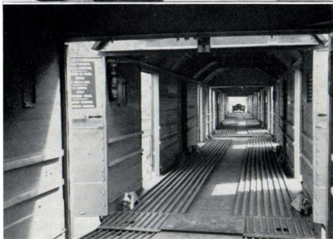
Enfilade des wagons prêts à recevoir leur chargement d'autos; c'est en fait, une sorte de long garage; au premier plan, à gauche et à droite, les sabots de calage prêts à servir
