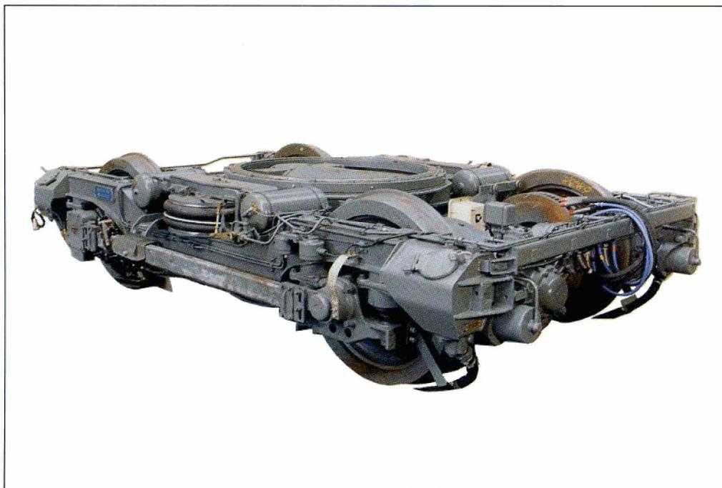
Bogie bi-moteur, et porteur de conception similaire, à suspension caoutchouc, utilisé sur les matériels de métro de la R.A.T.P.
