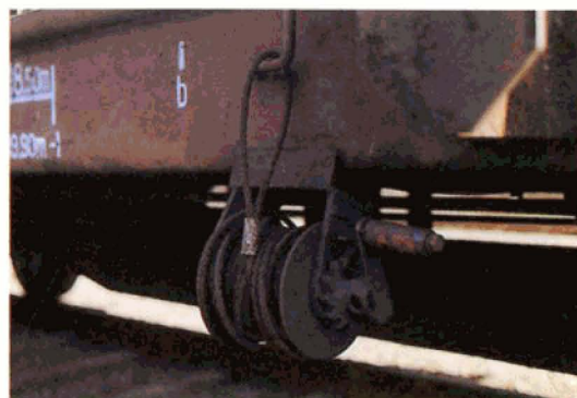
Oproltrommel voor kabel
