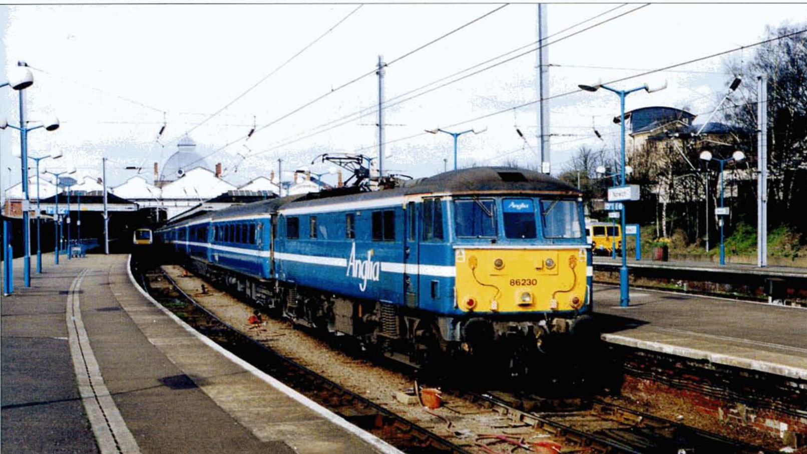
PHOTO 71-18 Départ de Norwich d'un train Anglia à destination de London, remorqué par la 86230. Les Class 86 furent construites par English Electric et Vulcan Foundry de 1965 à 1966 (Class 86/2 : 4550 kW - 86 t - 200 km/h). Philippe DE GIETER, 16 mars 2005.
