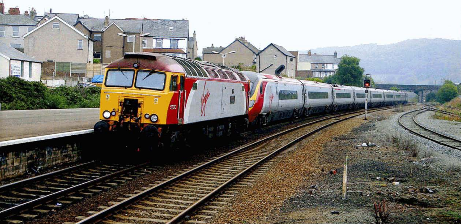
PHOTO 71-17 Le 6 octobre 2005, passage à Llanduno Junction d'une relation directe London Liverpool Street - Holyhead, assurée par une automotrice Pendolino de Virgin; cette rame est tractée sur la section Diesel Crewe - Holyhead par la 57310 (ex-Class 47 remotorisée avec un moteur Diesel GM645-12E3 de 2500 CV - 80 t - 120 km/h). Philippe DE GIETER.
