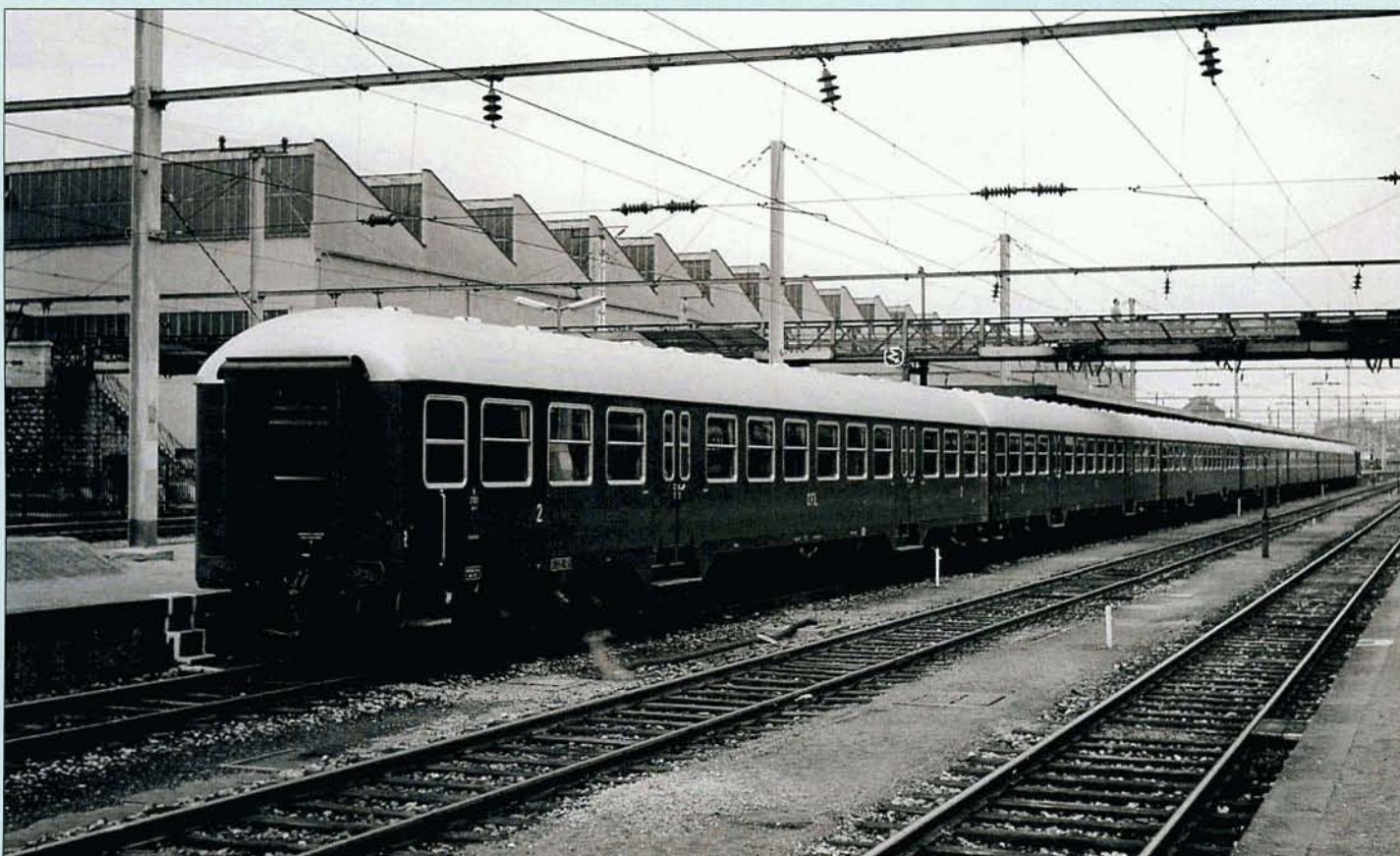
PHOTO BD-222 Une rame de voitures Wegmann neuves en gare de Luxembourg en mai 1965. En tête : la voiture B 2101. La parenté avec la voiture allemande Silberling ci-dessus est évidente. Bruno DEDONCKER, collection PFT.
