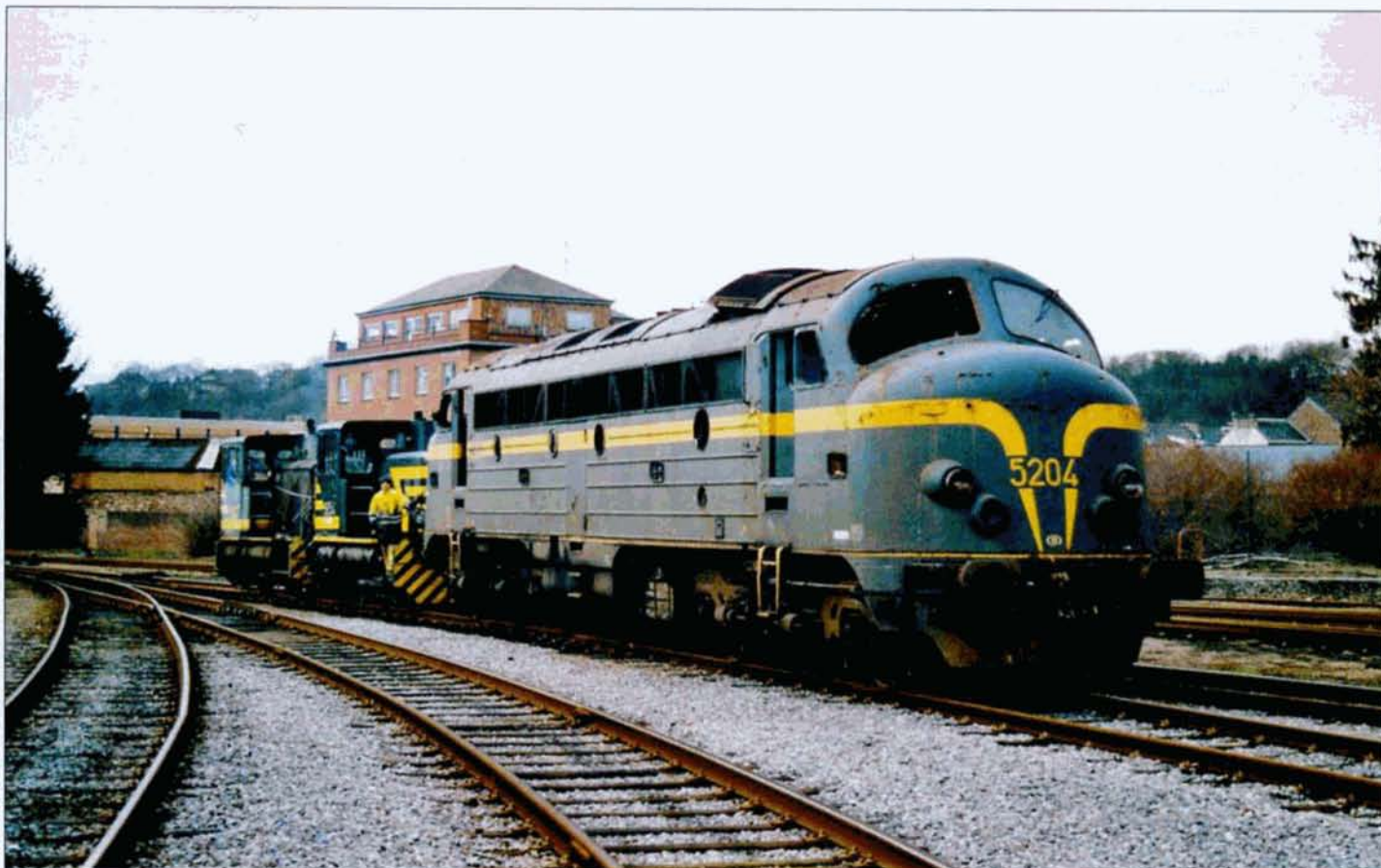
PHOTO 72-04 Le 17 février 2006, la 5204 a été transférée de Ronet à l'Atelier Central de Salzinnes dans le but d'échanger ses bogies avec ceux de la 1603 CFL, les bogies de cette dernière étant en effet à limite d'usure. Une fois révisés, les bogies de la 5204 (provenant en fait de la 5314 - voir EN LIGNES 66 pages 4-5). seront remis sous la 1603. La 5204 accompagnée par le 9154, est manoeuvrée par la 9147 dans l'enceinte de l'Atelier de Salzinnes. A noter que le 9154 se trouve aujourd'hui en Italie. PFT.
