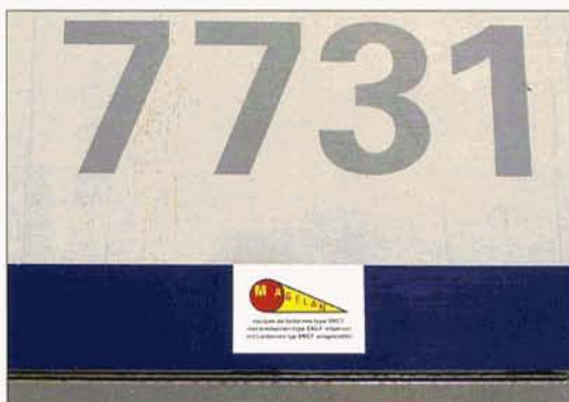
Ci-contre à gauche : gros plan sur les nouvelles lanternes Magelan de la SNCB. Ci-dessus, le pictogramme apposé sur les engins pourvus de ce type de disques, comme ici sur la 7731. Laurent JOSEPH.
