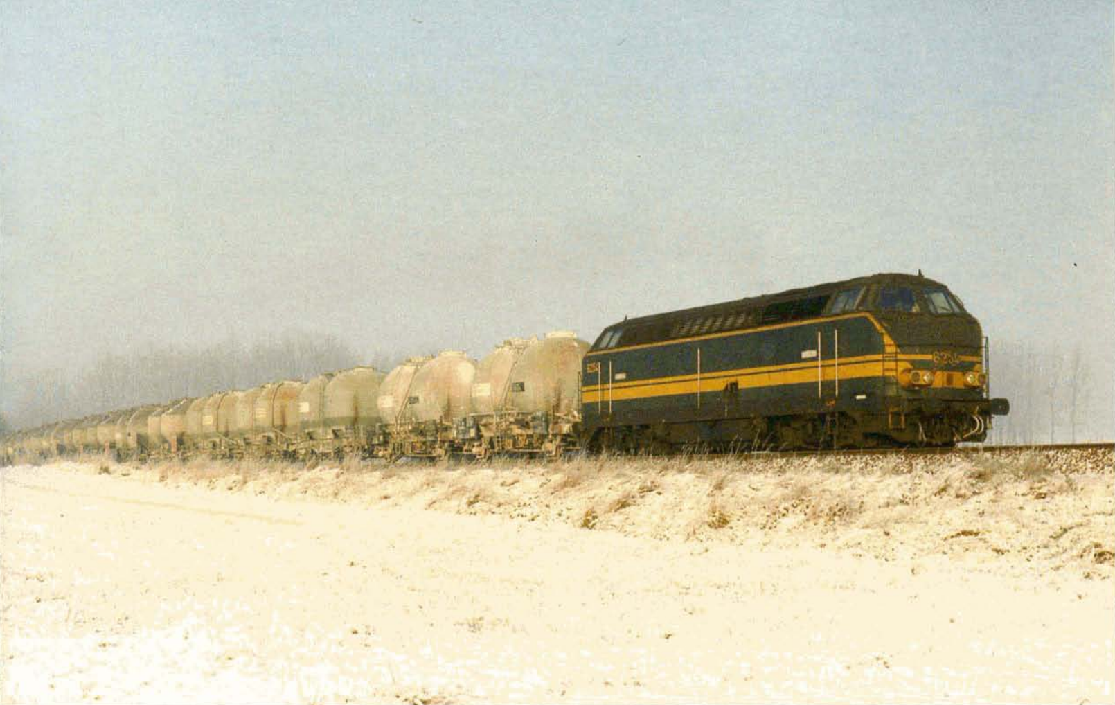
PHOTO 81-56 Le 5 janvier 1985, peu avant la gare de Viane-Moerbeke, passage du train de ciment vide 39890 Sint-Niklaas - Obourg. En tête, la 6254 de Ath. Les deux premiers wagons sont des Ucs 2000G2, les autres, plus récents, sont des types 2000G3 à 6.
