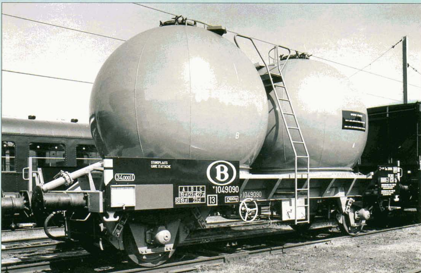
Le wagon Ucs type 2000G 1.049.090, photographié à sa sortie d'usine. A l'avant du véhicule, entre les buttoirs, on aperçoit la tuyauterie de prise d'air pour la vidange des réservoirs. Collection PFT.
