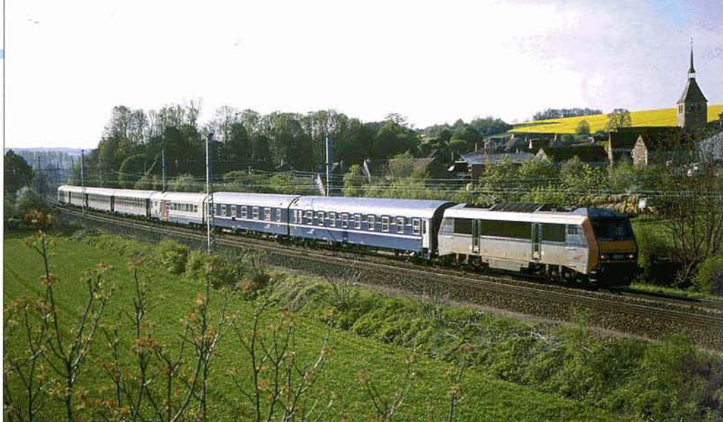
Traction classique (26000) mais composition anormalement réduite (deux T2, Restaurant FS, quatre Bc10ux) pour ce 224 Roma - Paris immortalisé le 27 avril 2004 entre Dijon et Paris dans la courbe de la BK 189. Gilbert LAURENT.
