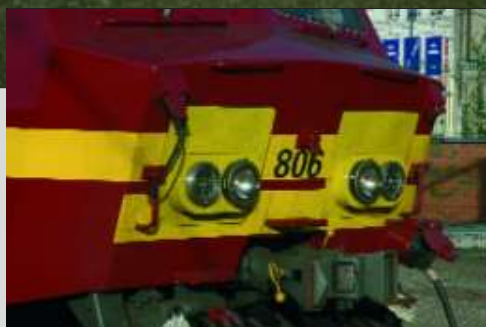
PHOTO 82-55 ↑ Plusieurs 800 sont ressorties de révision pourvues de nouveaux phares. A cette occasion, les portes des phares sont entièrement peintes en jaune (à comparer avec la photo de la 810 publiée dans le EL 64 page 35), comme ici la 806 à Erquelinnes, le 21 septembre 2007. Pierre HERBIET.
