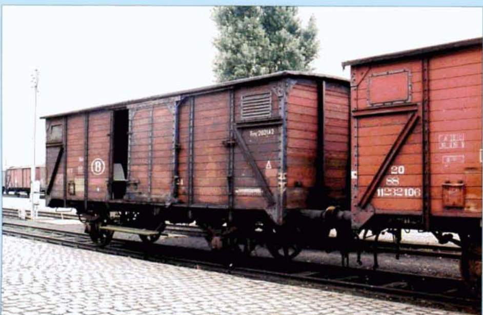
Voici un wagon du type 2021A2, dont le numéro UIC a été effacé de même que la croix de mise hors service. Il est prêt à être réutilisé comme véhicule de service. Antwerpen-Kiel, 1er septembre 1982. Charles OCSINBERG.
