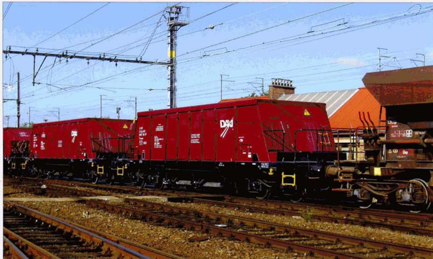
PHOTO 94-34 Les nouveaux wagons pour transport de ballast loués par Infrabel. Le premier wagon porte le numéro UIC 33 53 RO-GFR 6993 796-6 P. Schaerbeek, 17 septembre 2009. Jean-Luc VANDERHAEGEN.
