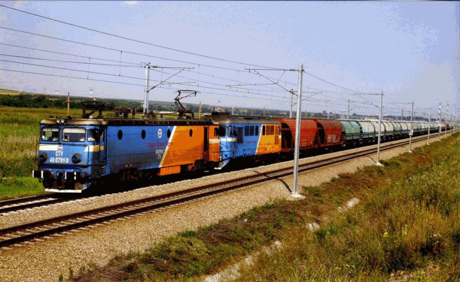
PHOTO 94-64 CTV (Cargo Trans Vagon) est principalement actif dans le transport de produits chimiques dans le sud-est du pays. Le 16 août 2009, les 40 0791-0 et 60 0169-7 en tête d'un train d'engrais circulent de Constanta vers Bucaresti, à Mircea Voda. Les 40 sont des Co'Co' construites par Electroputere de 1963 à 1991; les 60 sont des Co'Co' diesels-électriques construites également par Electroputere, de 1960 à 1993. Philippe DE GIETER.
