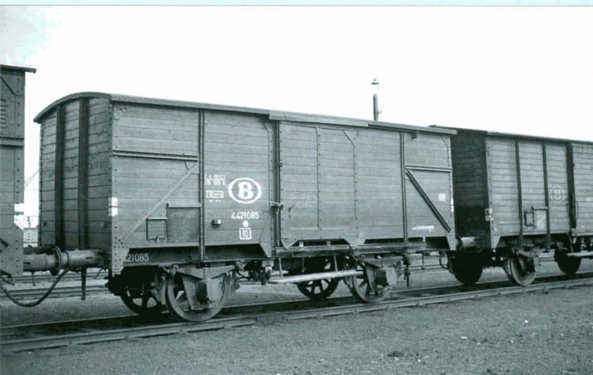
PHOTO 99-68 NB Wagon couvert 4.421.085 photographié à Oostende la 10 avril 1958. Les 3 premiers chiffres de son numéro signifient qu'il s'agit d'un wagon couvert (4), freiné (4), de 20 à moins de 25 t (2). Ce wagon de 21 t provient du War Department (WD). Sa caisse a été reconstruite et il sera classé dans le type 2000d puis 2000E1.
