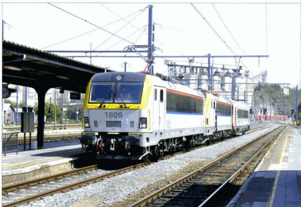
Le 2 juillet, les 1809 et 1810 accouplées à une voiture-pilote 111 BDx ont accompli un parcours d'essai entre Kinkempois et Jemelle, et retour. Notre photo montre l'arrivée du train à Jemelle. On remarquera les nouveaux isolateurs des caténaires déjà prévus pour la réélectrification en 25 kV de la ligne 162 Namur - Arlon. Ces isolateurs ont été placés lors des travaux de modernisation de la gare, débutés en 2009. Daniel MOENS.
