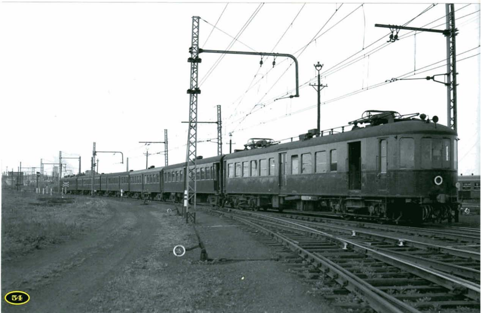
PHOTO BD-9902 En mars 1952, la rame n°1 renforcée par deux remorques, quitte l'atelier de traction électrique de Schaarbeek. La motrice visible en gros plan et portant un disque rouge devant le phare, est la 213.001, ex. 7301 (ACEC - AMN). Photo Bruno DEDONCKER, collection PFT ©.
