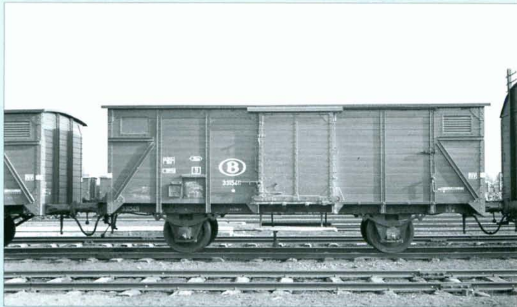
PHOTO 99-69 NB Wagon couvert 3.315.411 photographié à Bastogne le 12 mars 1956. Son numéro indique qu'il s'agit d'un wagon couvert (3), non freiné (3), de moins de 20 t (1). Photo Bruno DEDONCKER, collection PFT ©.
