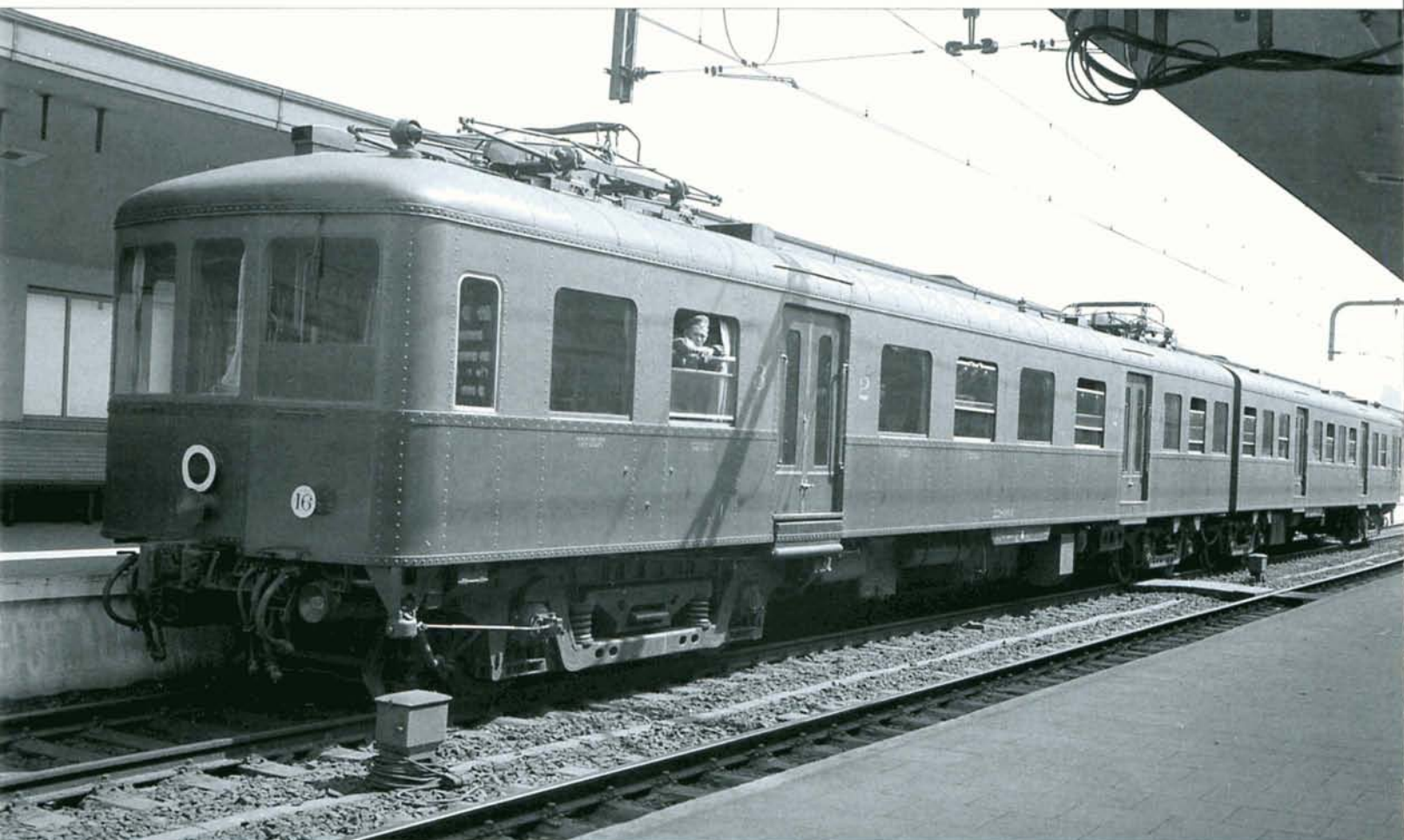
PHOTO BD-9904 La rame n° 16 / 228.004 en gare de Bruxelles-Nord, en deux tons de vert avec ceinture noire. On remarquera l'énorme bogie moteur à double châssis. Auteur inconnu, collection PFT ©
