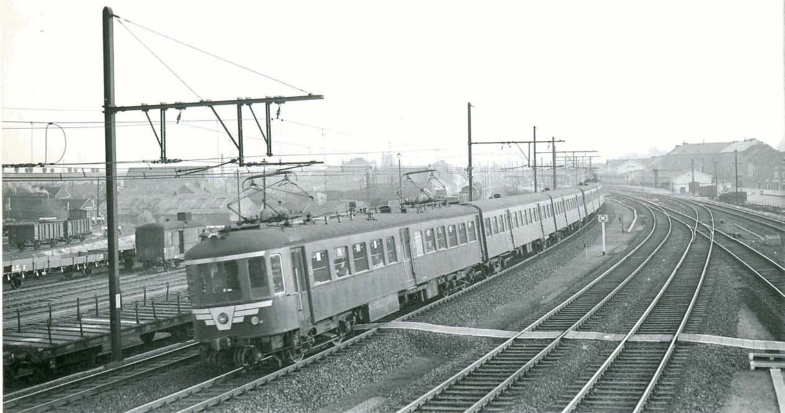
PHOTO BD-10103 Le 12 novembre 1955, la rame n°A3 vient de quitter la gare de Marchienne-au-Pont et se dirige vers Bruxelles et Antwerpen. Son feu blanc a été agrémenté de moustaches jaunes afin d'améliorer la visibilité. En outre, depuis novembre 1953, le numéro des rames a été modifié de 1 à 12 vers A1 à A12. A droite du train, on voit les deux voies de la ligne 124A, parallèle à la ligne 124 et, à l'extrême droite, les deux voies de la ligne 112 vers Piéton. Photo Bruno DEDONCKER, collection PFT ©.
