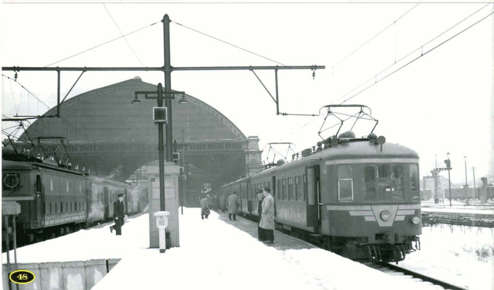
PHOTO BD-10104 Le 15 février 1955 en gare de Charleroi-Sud, les voyageurs embarquent à bord de la rame n° A2 devant assurer un semi-direct vers Bruxelles et Antwerpen. A gauche, une locomotive électrique de la série 101 attend le départ avec un train local. On remarquera la vapeur s'échappant des voitures M1 qui étaient préchauffées à la vapeur à l'aide d'une installation fixe. A Charleroi-Sud, seules les trois voies latérales, en impasse, étaient électrifiées. Ces voies n'existent plus aujourd'hui. Photo Bruno DEDONCKER, collection PFT ©.
