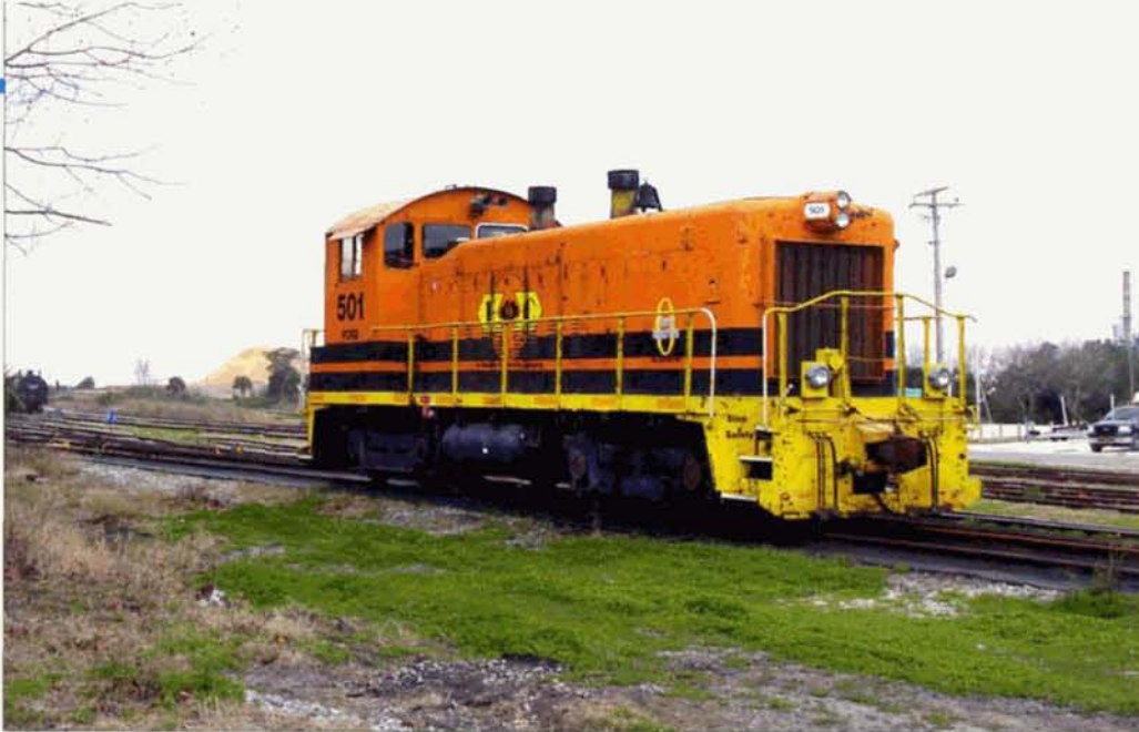
PHOTO 104-31 La SW1200 501 du First Class Railroad (FCRD) attend son prochain service dans le port de Fernandina Beach , en Floride. Cette shortline, propriété de GWI, est longue d'une cinquantaine de kilomètres. Les SW1200 sont des locomotives Diesel Bo'Bo' construites en 1056 exemplaires par GM-EMD entre 1954 et 1966. Elles disposent de 890 kW fournis par un moteur EMD 567C à 12 cylindres. La 501 FCRD a été livrée en 1964 au Missouri Pacific , avec le numéro 1176. Philippe DE GIETER, 24 février 2010.
