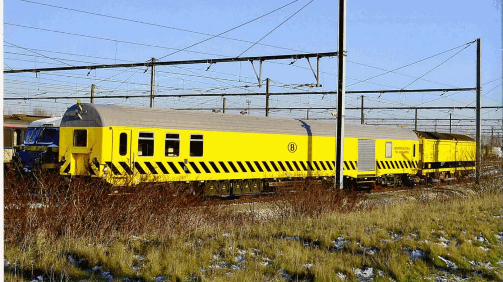
PHOTO 108-30 La nouvelle voiture de secours 90.001 de l'atelier d'Antwerpen-Noord, provient de la transformation du fourgon Dms 17434. Antwerpen-Noord, 1er février 2012. Tommy MAEREMANS.
