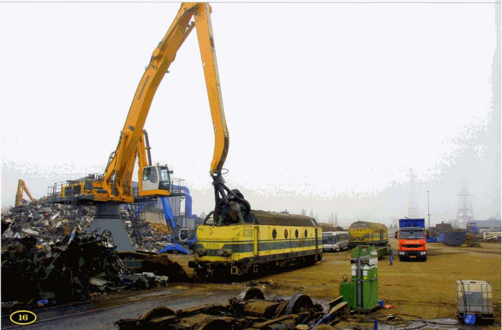
PHOTO 108-24 ↑ - PHOTO 108-25 ↓ Le 8 novembre 2011, ce sont les 6298 et 5125 qui furent réduites en lambeaux de métal. Chaque morceau sera ensuite envoyé dans la déchiqueteuse visible derrière la grue, et en ressortira à l'état de limaille. Celle-ci est capable d'avaler un demi wagon plat dans le sens de la longueur ! Photos Pierre HERBIET.
