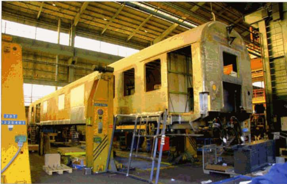
Les travaux de carrosserie, avec la suppression de l'intercirculation, l'obturation des anciennes portes d'accès au fourgon et l'ouverture pour de nouvelles portes donnant accès au compartiment à outillage.
