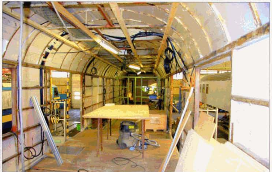
A droite, le poste d'observation installé à la place de l'intercirculation. Il sera équipé d'une radio et d'un frein d'urgence. Salzinnes, 17 janvier 2012.
