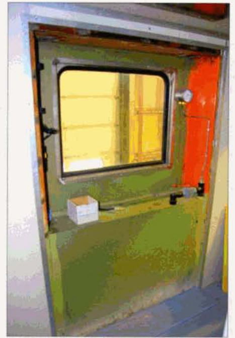
Les travaux de carrosserie, avec la suppression de l'intercirculation, l'obturation des anciennes portes d'accès au fourgon et l'ouverture pour de nouvelles portes donnant accès au compartiment à outillage.
