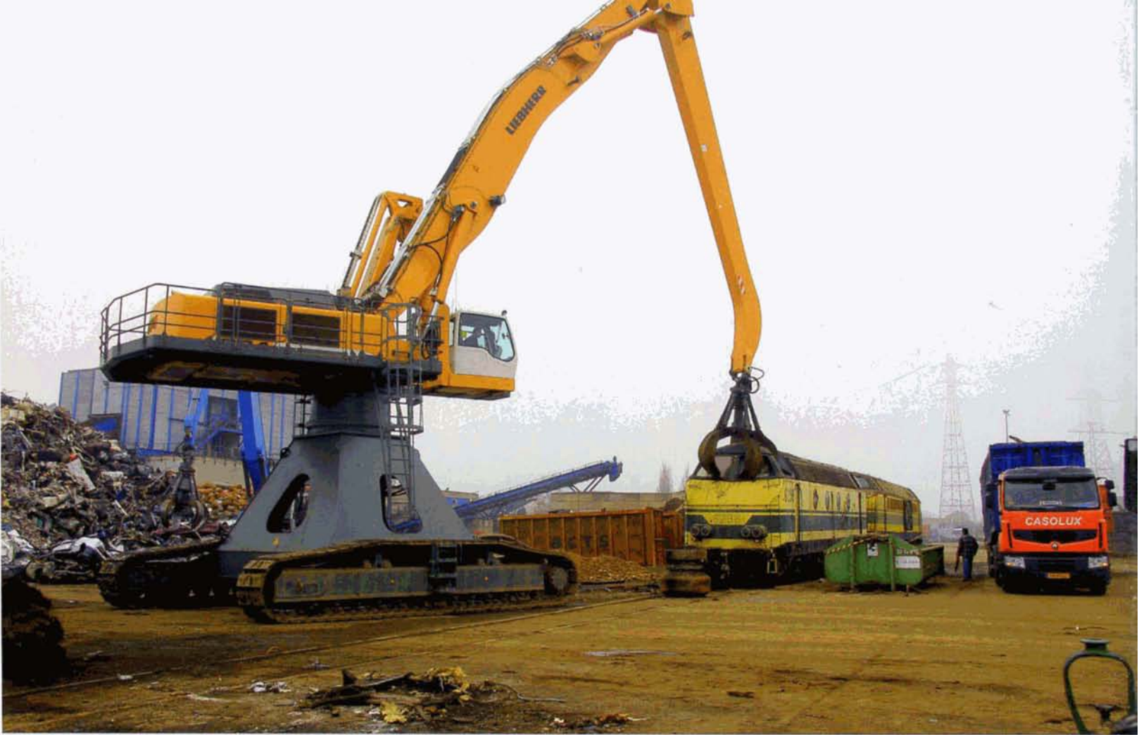
PHOTO 108-24 ↑ - PHOTO 108-25 ↓ Le 8 novembre 2011, ce sont les 6298 et 5125 qui furent réduites en lambeaux de métal. Chaque morceau sera ensuite envoyé dans la déchiqueteuse visible derrière la grue, et en ressortira à l'état de limaille. Celle-ci est capable d'avaler un demi wagon plat dans le sens de la longueur ! Photos Pierre HERBIET.
