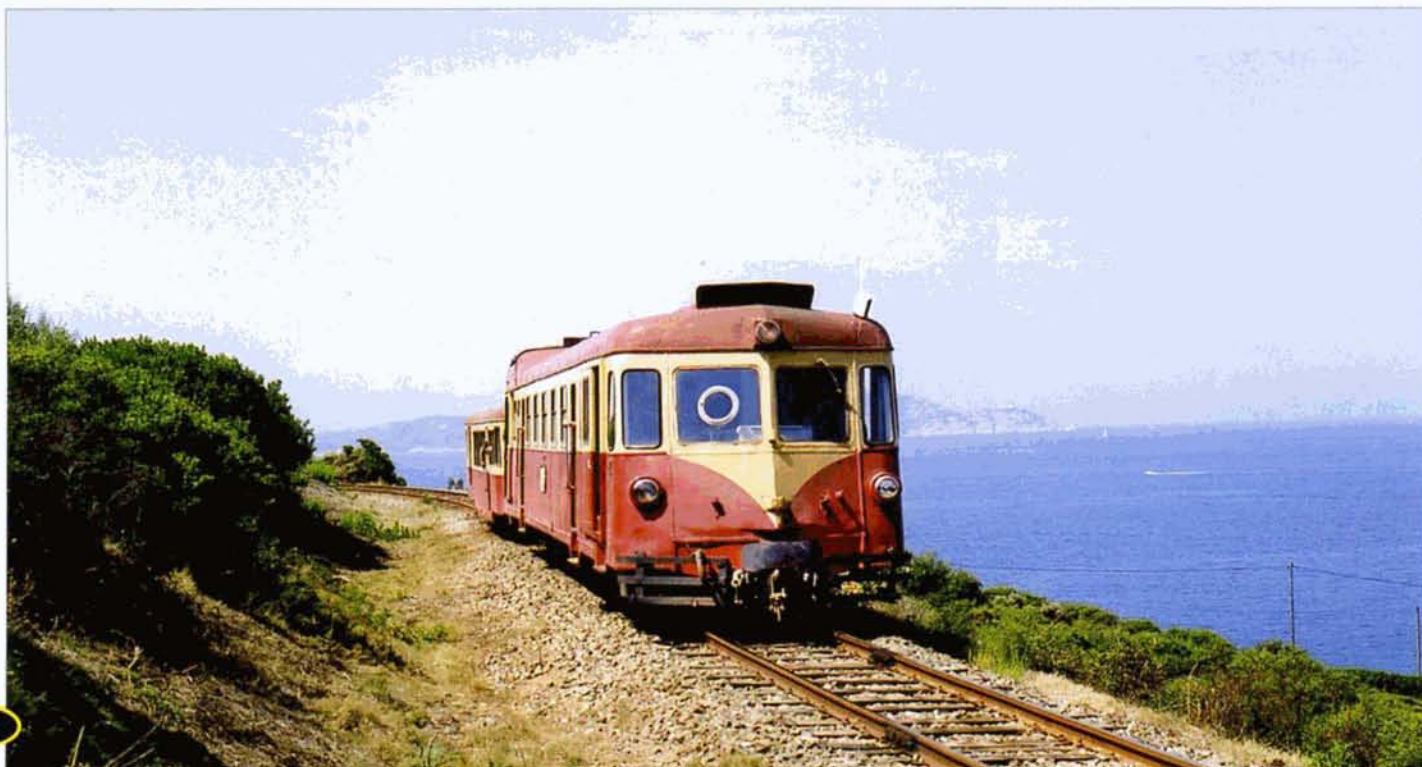
PHOTO 108-86 Le X204 et la remorque XR113 circulant comme train 60 Calvi-Ile Rousse longent la Baie de Calvi à Ondari-Arinella le 10 août 2004. La remorque XR113 est un autorail Billard A150D de 1938, démotorisé en 1986 et utilisé comme voiture-pilote. Philippe DE GIETER.
