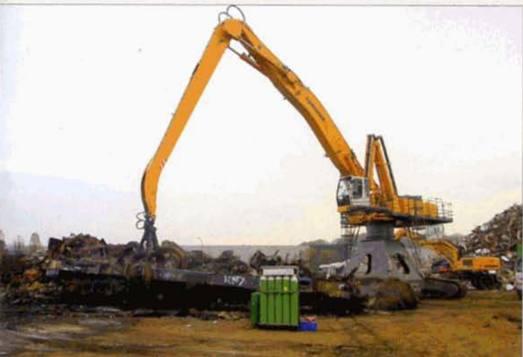
PHOTO 108-22 ↓ - PHOTO 108-23 ↘ A gauche, le bras agrippe le châssis et va le retourner sans difficulté (vue de droite).
