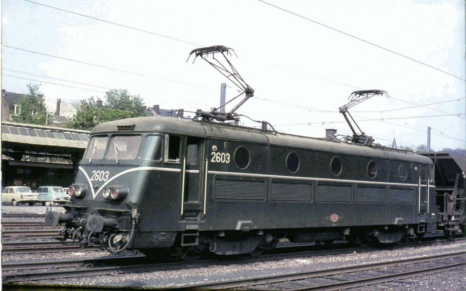
**PHOTO-THEME 109** La 2603 en gare de Namur. On remarquera que les ressorts à lames de sa suspension secondaire sont déjà supprimés (voir repère (5) sur la photo du milieu page 17). Elle n'est pas encore pourvue des câblots pour la circulation en unité multiple. Photo Julien CASIER, collection PFT.
