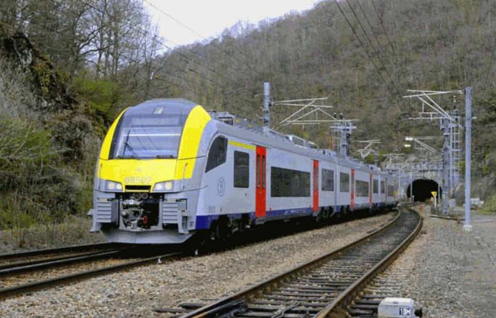
Le 17 avril, l'automotrice Desiro 08502 arrive à Houyet, lors d'un parcours d'essai destiné à contrôler le comportement thermique de l'équipement 25 kV (température du transformateur). Dominique ALLARD.
