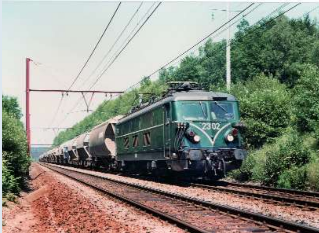
FOTOTHEMA 71 Op 8 juli 1982 beklimt een trein met chemische producten, getrokken door de 2302, de hellingen van de Luxemburglijn. Hij zal binnen enkele ogenblikken het hoogste punt van de lijn te Libramont bereiken. Sinds 1976 is de 2302 voorzien van dubbele koplampen en kabels voor het rijden in treinschakeling. Pierre HERBIET.
