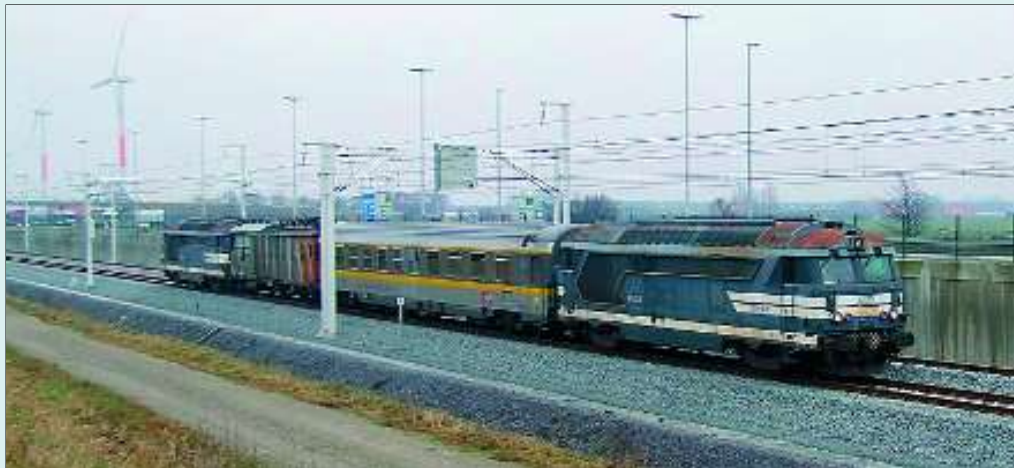
De Franse meettrein staat klaar aan de Belgisch-Nederlandse grens voor de terugrit. Vooraan BB67251, meetrijtuig Lucie, meetwaggen Vulcain en BB67250. R. Korving.
