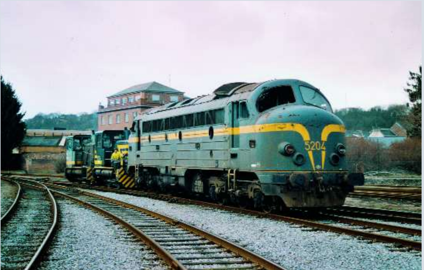
FOTO 72-04 Op 17 februari 2006 werd de 5204 overgebracht van Ronet naar de centrale werkplaats van Salzinnes. Daar zullen de draaistellen verwisseld worden met deze van de 1603 ex-CFL. De draaistellen van de 1603 zijn versleten en eenmaal de draaistellen van de 5204 gereviseerd zijn worden deze onder de 1603 geplaatst. De 9117 en 9154 slepen samen de 5204 op de terreinen van de CW van Salzinnes. TSP.
