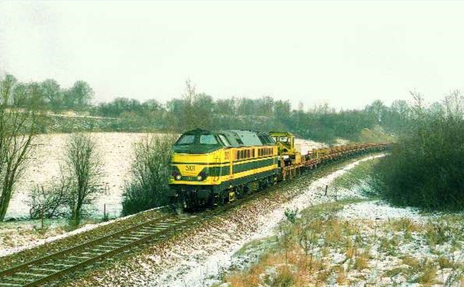
FOTO 76-08 Op 7 februari 1991 sleepte de 5101, ex-5001, een trein met langgelaste rails tussen Schaarbeek en Mariembourg. Het konvooi daalt de steile helling (20 ‰) af tussen Neuvilles en Mariembourg. Pierre HERBIET.
