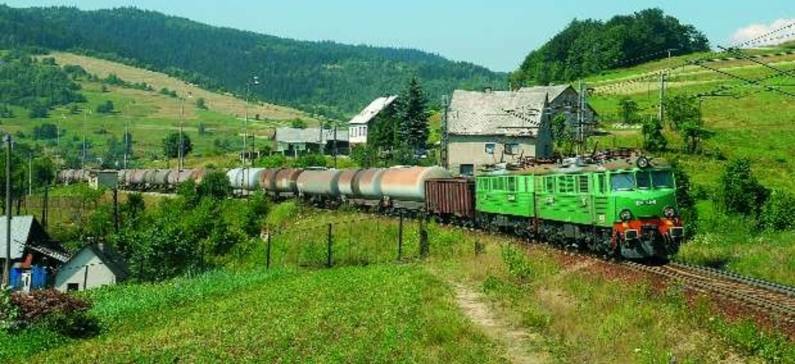
FOTO 77-06 De firma Cegielski bouwde tussen 1977 en 1983 tweehonderd tweeledige locomotieven van de reeks ET41 "Jamnik". Deze Bo'Bo' + Bo'Bo' met een massa tussen 160 en 167 ton ontwikkelen 4000 kW. Ze worden gebruikt voor zware goederendiensten. 20 juli 2006, de ET 41-168 aan het werk op de zware bergachtige lijn van Krakow naar Cadca in Slowakije. De trein werd gefotografeerd in de buurt van het station van Skalité bij kilometerpaal 21 op Slowaaks grondgebied. Yves STEENEBRUGGEN.
