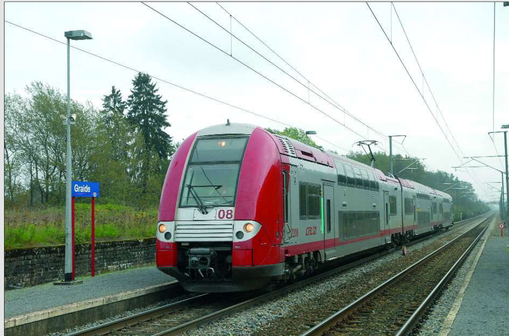
FOTO 77-48 De 2208 van de CFL tijdens het uitvoeren van de elektromagnetische compatibiliteitsproeven in Graide, op 28 oktober 2006. Yves STEENEBRUGGEN.
