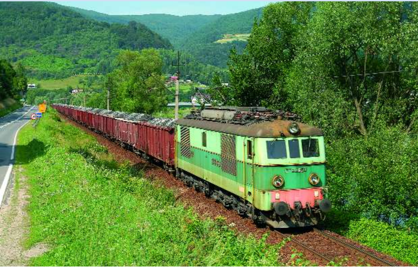
FOTO 77-07 De Co'Co's van de reeks ET 21 behoren tot de oudste elektrische locomotieven van de PKP. Van de 658 exemplaren, gebouwd tussen 1957 en 1971 door PAFAWAG (+ 68 gebouwd voor industriële netten), zijn er nog een tiental in dienst. Vanuit de stelplaats van Nowy Sacz worden ze vooral ingezet voor het opdrukken van treinen op het bergachtig stuk naar Plavec in Slowakije. Ze kregen de bijnaam "Sputnik" en ontwikkelen 1800 kW voor een massa tussen 113 en 120 ton. Op 20 juli 2006, dicht bij Sucha Struga, sleept de ET 21-653 een zware kolentrein naar Muszyna aan de Slowaakse grens. Yves STEENEBRUGGEN.
