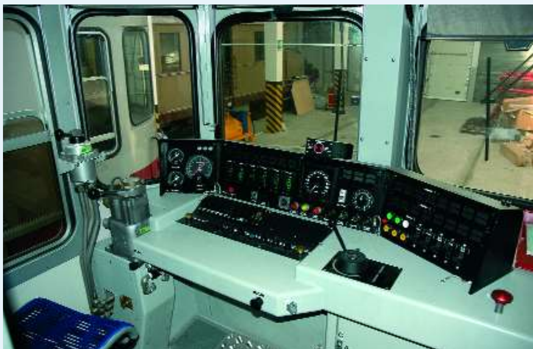
↑ FOTO 77-11 De bedieningstafels in de stuurposten werden volledig verbouwd en bezetten nu de volledige breedte van de kast. De omvormingswerken werden uitgevoerd door de firma Metalmeccanica Milanese. Kostprijs : € 370.000 per stel.
