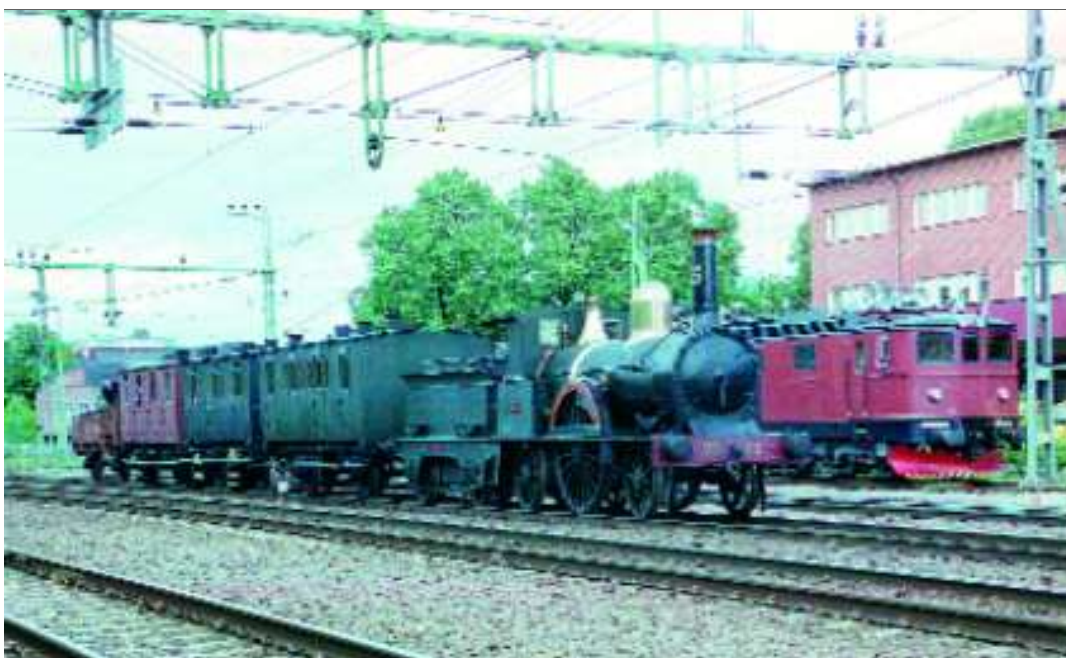
OTO 78-13 Links : de Dg 101 van het museum van Gävle. Ze maakte deel uit van het eerste lot locs met asindeling 1C1 (met drijfstangen). Men bouwde 93 machines tussen 1925 en 1933 met een houten kast. Ze werden later gemoderniseerd, maar behielden hun originele kast. Rechts : de Pacific F 1200, het eerste exemplaar van elf compound-locomotieven met vier cilinders, gebouwd tussen 1914 en 1916 door NoHAB (90 km/h - 142,8 t). Deze reeks werd in 1937 verkocht aan de DSB. Gävle, 10 september 2006. Yves STEENEBRUGGEN.
