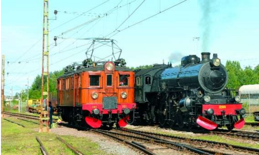
OTO 78-13 Links : de Dg 101 van het museum van Gävle. Ze maakte deel uit van het eerste lot locs met asindeling 1C1 (met drijfstangen). Men bouwde 93 machines tussen 1925 en 1933 met een houten kast. Ze werden later gemoderniseerd, maar behielden hun originele kast. Rechts : de Pacific F 1200, het eerste exemplaar van elf compound-locomotieven met vier cilinders, gebouwd tussen 1914 en 1916 door NoHAB (90 km/h - 142,8 t). Deze reeks werd in 1937 verkocht aan de DSB. Gävle, 10 september 2006. Yves STEENEBRUGGEN.
