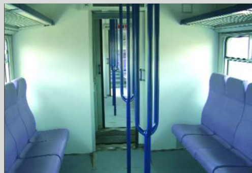
Hierboven : in de beide kleine afdelingen tweede klasse zijn tegen de zijwanden klapstoeltjes geplaatst. In het midden zijn handgrepen aangebracht om een maximaal aantal reizigers te kunnen "stouwen"...
