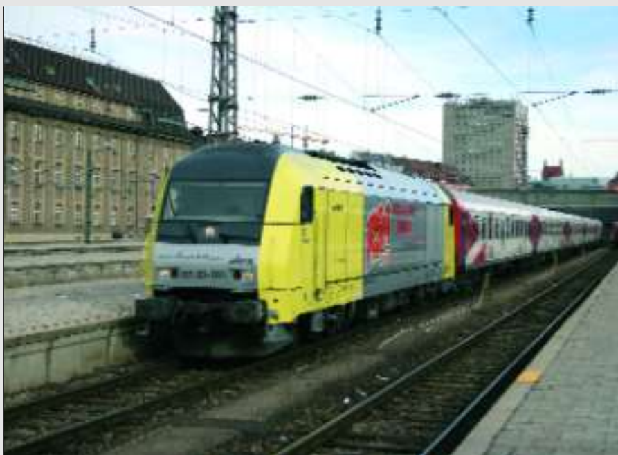
FOTO 78-77 De Deense Spoorwegen hebben een reeks van 13 6-assige EuroSprinters met een vermogen van 6500 kW besteld voor het verkeer in de tunnel van Storebelt waarvan de toegangshellingen een stijging van 15 % bereiken. 14 augustus 2004, doorrit te Ullerslev van EG 3107. Yves STEENEBRUGGEN.
