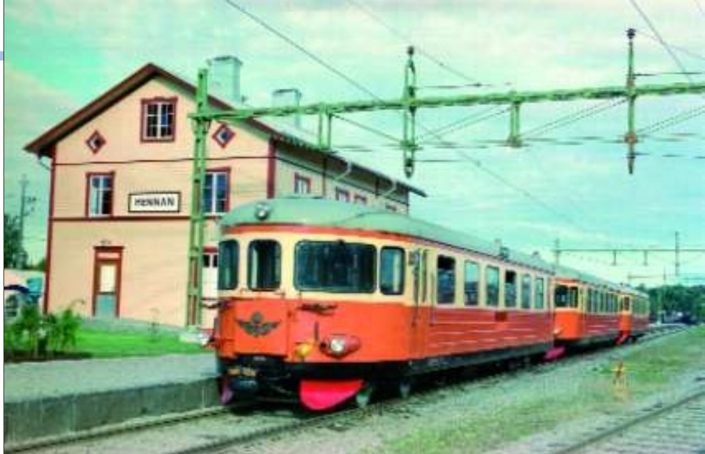
Een trein bestaande uit drie historische motorwagens met op kop de Y8-1076, komt aan te Hennan. Er werden tussen 1953 en 1968 meer dan 150 soortgelijke motorwagens (145 kW - 115 km/h - 19 t - mechanische transmissie) geleverd aan de Zweedse Spoorwegen. Er bestonden drie subreeksen (Y6, Y7 en Y8). Er bestond zelfs een elektrische versie (X16), een smalspoorversie (YP) en aanhangwagens (met of zonder stuurpost). Arno VEENHOF.
