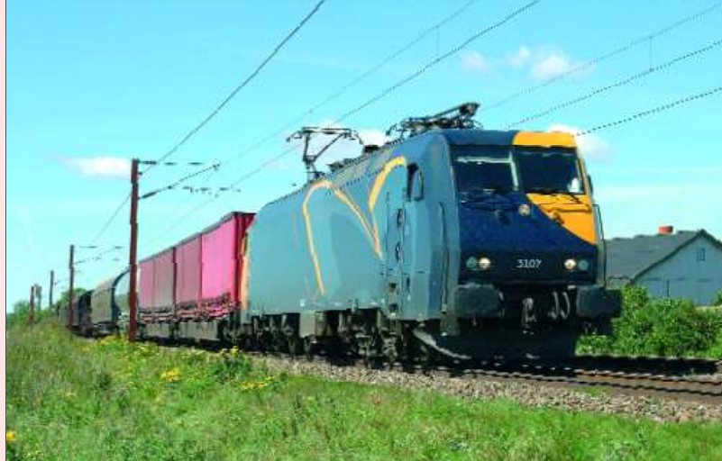
FOTO 78-77 De Deense Spoorwegen hebben een reeks van 13 6-assige EuroSprinters met een vermogen van 6500 kW besteld voor het verkeer in de tunnel van Storebelt waarvan de toegangshellingen een stijging van 15 % bereiken. 14 augustus 2004, doorrit te Ullerslev van EG 3107. Yves STEENEBRUGGEN.
