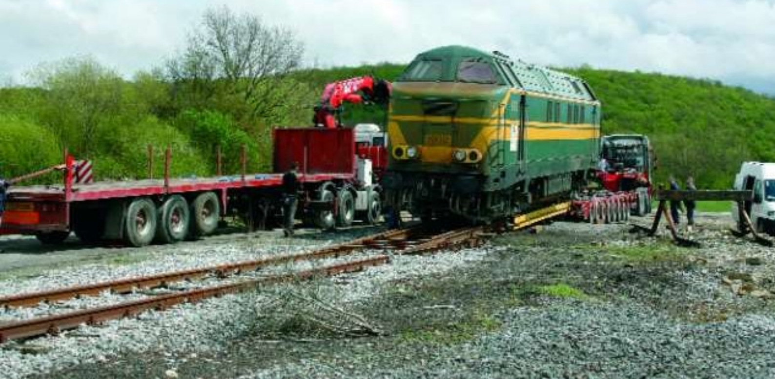
FOTO 86-58 De 6019 werd op 29 april 2008 gelost te Mariembourg. Het betreft een spectaculaire handeling : de loc wordt via een brug met indrukwekkende helling de oplegger afgereden. Serge MARTIN.
