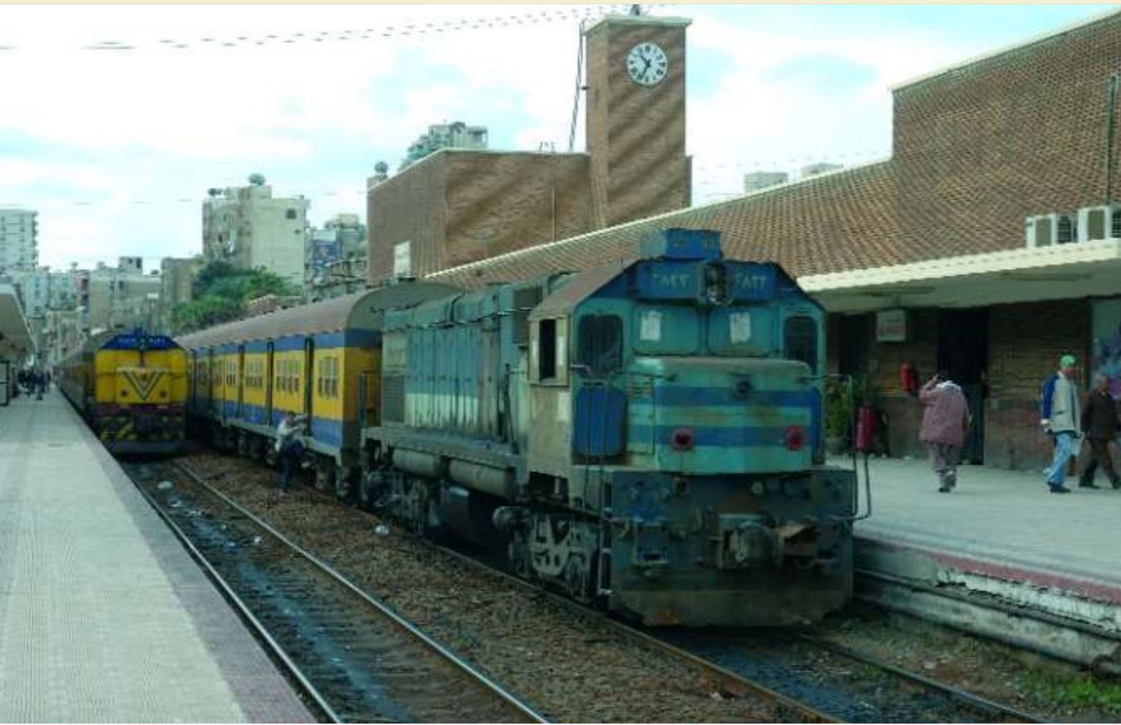
FOTO 86-89 ↓ In het station van Sidi Gaber, wachten op 16 december 2007 twee voorstadstreinen op het vertreksein. Zij zijn samengesteld uit trek- en duwstellen met locomotieven van de reeks 3800-3900. Wanneer zij de trein duwen, zijn alle vensters van de machine door metalen platen afgeschermd. Aan de rechterkant ziet men de 3833, aan de linkerkant de 3839. Yves STEENEBRUGGEN.
