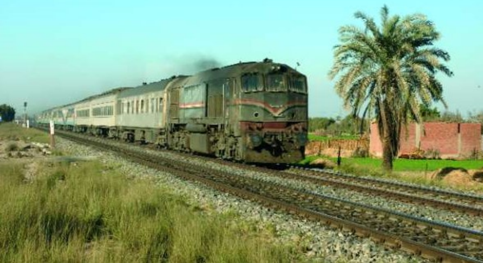
FOTO 86-86 De toestand van het materiaal is ver van schitterend. Hier de doorrit van een directe trein te Sindiyān die door de niet al te frisse 3224 wordt gesleept, op 15 december 2007. Deze loc maakt deel uit van een reeks van 38 Co'Co's gebouwd in 1960 door GM (type EMD JT22C). Deze machines van 1325 kW, 115 t zwaar halen een snelheid van 120 km/h. Zij zijn uitgerust met een GM-dieselmotor type 16-567C. Yves STEENEBRUGGEN.
