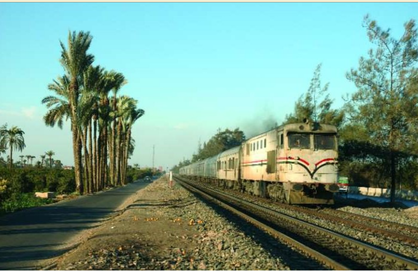
FOTO 86-87 Van 1975 tot 1984 leverde Henschel een grote reeks Co'Co's van 352 eenheden (type AA 22T, reeksen 3000, 3100 en 3200). Deze locomotieven met elektrische overbrenging zijn voorzien van een GM-motor type 12-645E3 van 1655 kW en kunnen aan 120 km/h rijden. Op 15 december 2007 heeft de 3095 zojuist het station van Tukh verlaten. Thierry NICOLAS.
