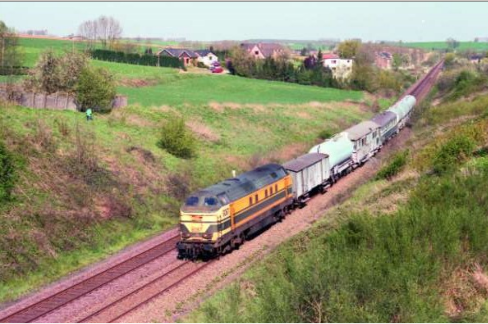
FOTO 87-12 De onkruidverdelgingstrein in actie te Rognon op lijn 123 Edingen - Braine-le-Comte. 21 april 1988.
