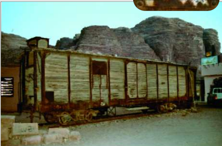
↓↑ De gesloten wagen die dienst doet als souvenirwinkel. Dit voertuig, van het type Kh, is uitgerust met een remmershuis. Wadi Rum, 30 december 2007. Philippe VERELST.
