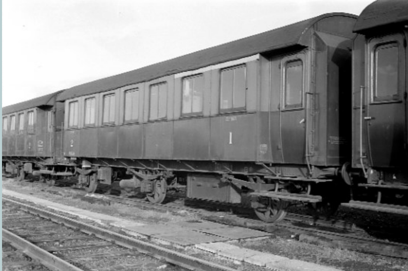
FOTO BD-287 Een T-rijtuigstel gevormd met rijtuigen AB 83.359 (midden) B 83.559 (rechts), gefotografeerd te Schaarbeek op 23 november 1957. Dit zijn twee Beierse rijtuigen van het type C3iBay99a, waarvan de 83.359 eerder al tot BC omgebouwd werd. Beide rijtuigen hebben gebogen buitendeuren. Dit T-rijtuigstel werd buitendienst gesteld met PV 427 van 17 december 1958. Bruno DEDONCKER, verzameling TSP ©.
