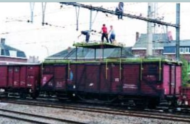
Wagen nr. 8 (oud UIC-nr. 21 88 2187 008) werd door de firma AUXELTRA gebruikt als platformwagen voor werken aan de bovenleiding (type 9472B2 - UIC-nr. 30 88 9472 376-8P). Fernand MAES, juli 1981.
