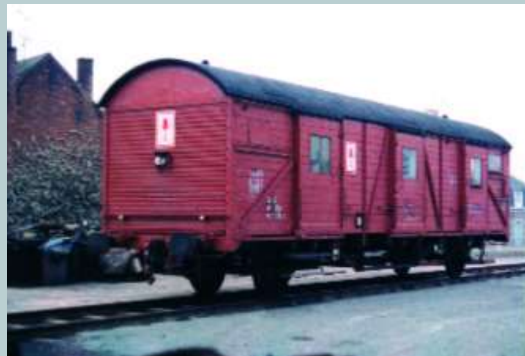
Na hun schrapping werden talrijke autotransportwagens verder gebruikt als dienstvoertuig. De voormalige wagen nr. 4 (21 88 218 004) kreeg een nieuwe bestemming als lokaal. Het chassis van de eerste 15 autotransportwagens (nrs. 1 t/m 15) was afkomstig van T-rijtuigen. Ze waren herkenbaar aan de schuifdeuren (drie in elke zijwand) en aan de rolluiken op de uiteinden. Fernand MAES, juli 1981.
