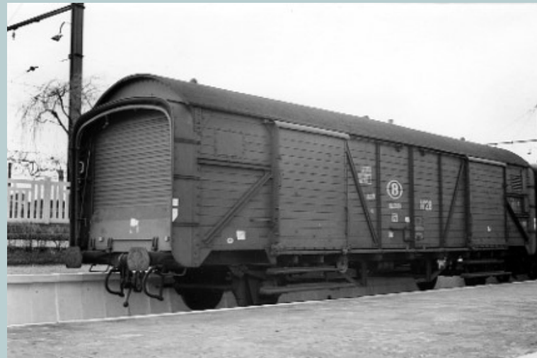
FOTO BD-164 De eerste autotransportwagens voor de autoslaaptreinen werden gebouwd op het chassis van de 30 Beierse rijtuigen, afkomstig van de T-rijtuigen. Hier zien we wagen 28, de 1.042.028 van het type Hbckss, gefotografeerd te Schaarbeek op 26 maart 1959. Bruno DEDONCKER, verzameling TSP ©.
