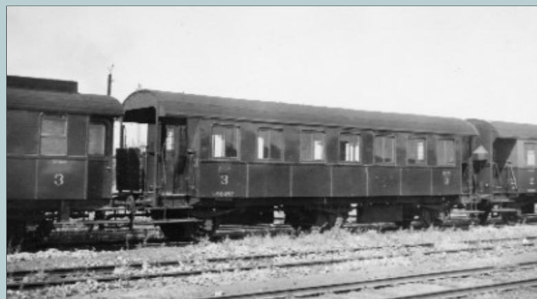
BC-rijtuig 83.682 (linker foto) - van Pruisische herkomst - en C-rijtuig 83.482 (rechter foto) - afkomstig uit Beieren - werden te Schaarbeek gefotografeerd in augustus 1951. Elk van beide rijtuigen is in feite een gehalveerd T-rijtuigenstel dat geschrapt werd. Later zullen ze samen gebruikt worden om het nieuwe rijtuigenstel 83.482 + 83.682 te vormen. De twee rijtuigen zijn hier nog niet omgebouwd en dragen de uniforme donkergroene livrei. Na haar schrapping werd rijtuig 83.682 gebruikt voor de bouw van een autotransportwagen, die op 23 juni 1958 buitenrolde uit de CW van Gentbrugge en in nachttreinen zou worden opgenomen. Foto G. DESBARAX, verzameling Bruno DEDONCKER / TSP ©.
