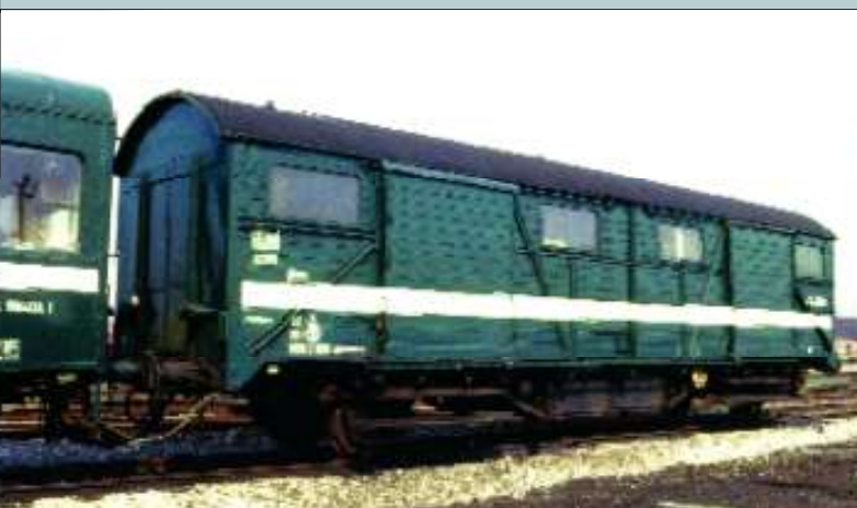
Enkele wagens werden toegewezen aan hersporingstreinen. Hier deze van de werkplaats Hasselt op 15 april 1984 (type 9582B8 - UIC-nr. 40 88 9582 806-4) die behoorde tot de tweede reeks (16 t/m 30) en slechts twee schuifdeuren in de zijwand had. Ch. OCSINBERG.
