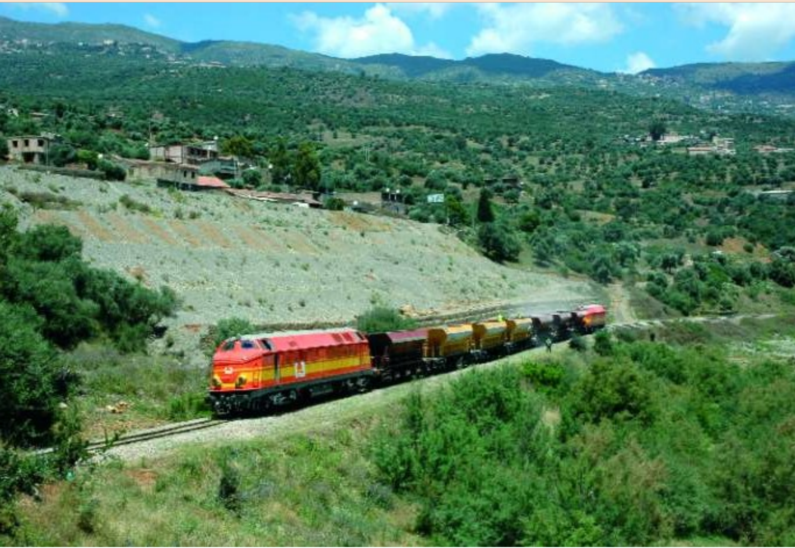
FOTO 87-96 Een ballastrein bestaande uit zeven tremelwagens, wordt gelost te Seddouk.
