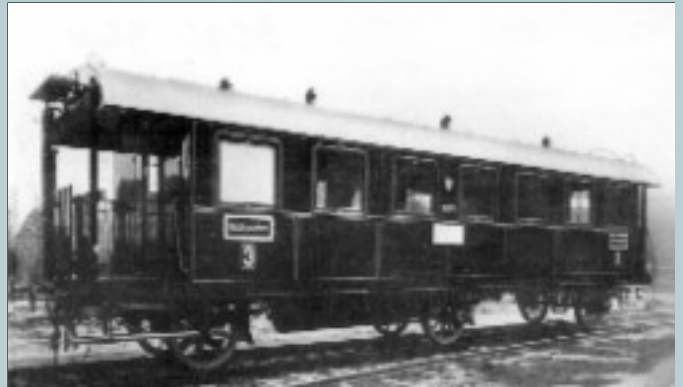
Op het einde van de jaren 1890 namen de Beierse sporenwegen de rijtuigen type C3i in dienst. Hier zien wij het rijtuig C3i (Bay13) nr. 10219 nog steeds in de oorspronkelijke K.Sts.B (Königliche Bayerische Staatseisenbahn). Deze sub-reeks werd gebouwd tussen 1313 en 1917. Verz. Bruno DEDONCKER / TSP ©.
