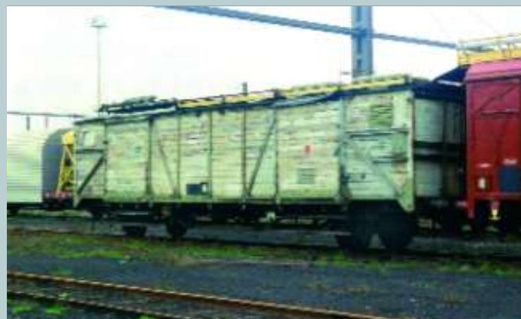
De firma ENGEMA gebruikte eveneens een aantal wagens voor werken aan de bovenleiding. Een wagen van het type 9472B1 (UIC-nr. 46 88 9572 275-0P). Muizen, 1 november 1989. Charles. OCSINBERG.
