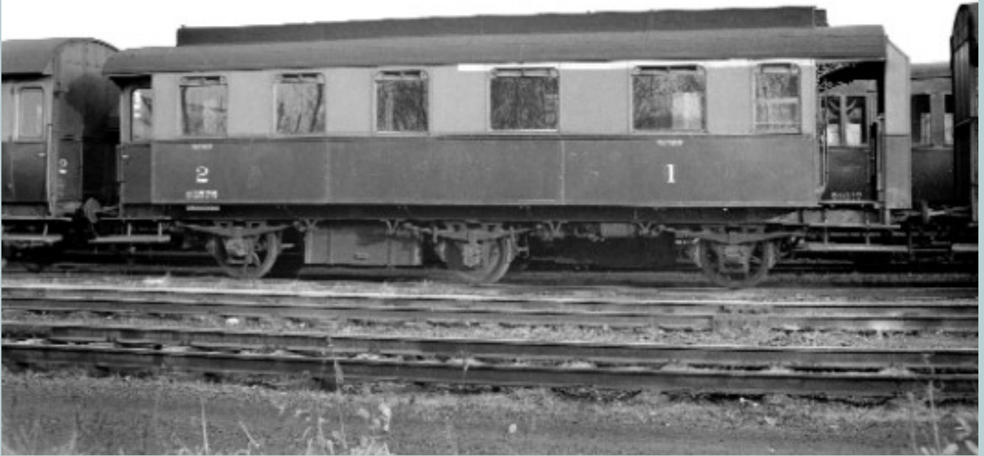
FOTO BD-288 AB-rijtuig 83.575 in twee tinten groen, gefotografeerd te Schaarbeek op 23 november 1957. Dit rijtuig van Pruisische afkomst (type BC3iPr10) werd aan het Beierse rijtuig 83.375 gekoppeld (C3iBay99a). Met het PV 427 van 17 december 1958 werd het geschrapt. Bruno DEDONCKER, verzameling TSP ©.
