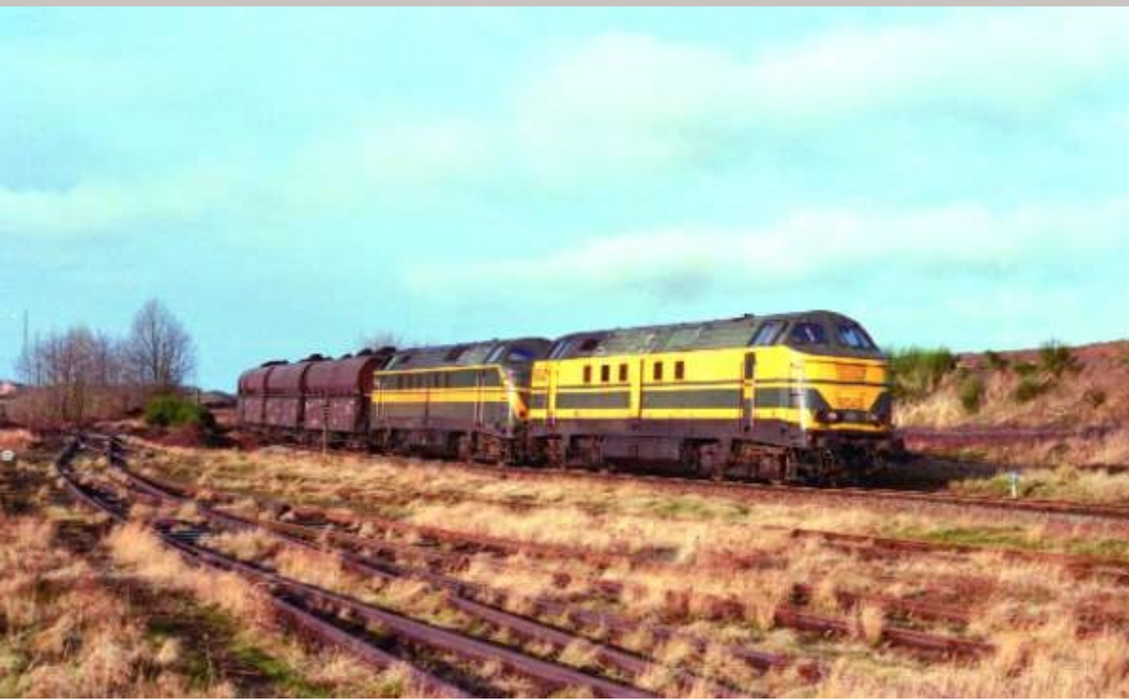
FOTO 87-13 Op 3 februari verlaten de 6040 en de 6034 Warquignies met steenkooltrein 28931 met bestemming de elektrische centrale van Ruien. De beide 60'ers bevinden zich achteraan de trein, terwijl vooraan een locomotief van de reeks 82 de trein tot in Saint-Ghislain sleept. Hier wordt de 82'er afgehaakt en de kolentrein kan onmiddellijk in de andere richting naar Ruien vertrekken. De 6040 stond na een ongeval afgesteld in afwachting van haar schrapping, maar werd toch hersteld en terug in dienst genomen. Serge. MARTIN.
