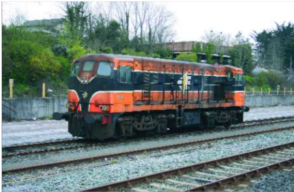
FOTO 89-43 De Bo'Bo' 170 te Mallow op 18 april 2008. Deze locomotief (massa 67 t) die ondertussen werd verschroot, maakte deel uit van een reeks van 37 machines (141 t/m 177) die werden gebouwd door GM tijdens de jaren 1962/1963. Ze waren voorzien van een GM-dieselmotor (709 kW) type 567CR met 8 cilinders. Midden oktober 2008 waren nog 12 machines van deze reeks in dienst. Philippe DE GIETER.
