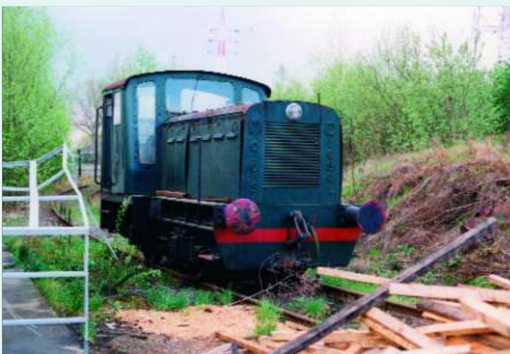
↑ De twee andere locotractoren, beide gebouwd door Moës te Waremme, staan reeds geruime tijd afgesteld. De eerste is van het type LNDC4, weegt 16 ton en heeft een vermogen van 68 pk. Luk GIBENS, 1996.
