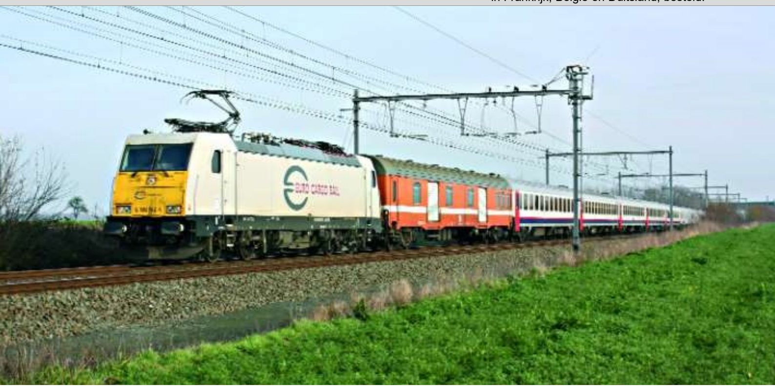
FOTO 89-27 ↓ De testtrein bestond uit een Frans meetrijtuig, zeven I10-rijtuigen, drie Dms-pakwagens en de 1322 (achteraan). Bois du Coucou, 30 november 2008. Christian AUCQUIERE.
