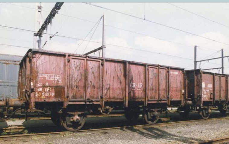
Twee wagens type 1212G2. Links de 21 88 502 9 2189-9; rechts de 21 88 502 9 205-8 die is uitgerust met een nokstang en die zal omgevormd worden als 1212G3 of 1202A1. Deze twee voertuigen staan uitgeweken in Haine-Saint-Pierre om eventueel tentoongesteld te worden in het toekomstig spoorwegmuseum. Charles OCSINBERG.
