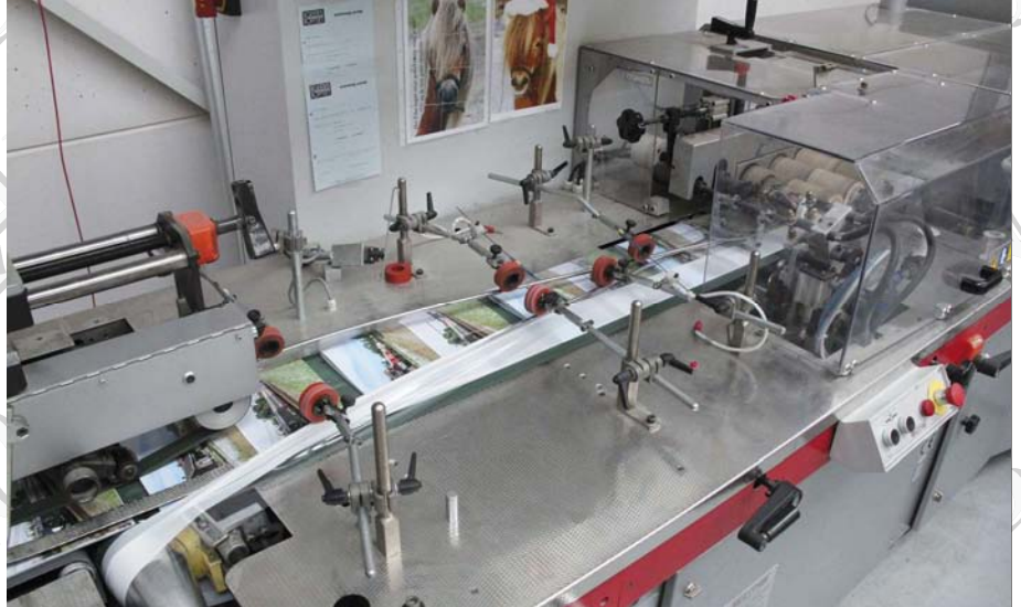
↑ De Sitma 950-verpakkingsmachine steekt de tijdschriften onder folie tegen een ritme van 20.000 exemplaren per uur. Indien gewenst kunnen nog losse bladen worden toegevoegd.
