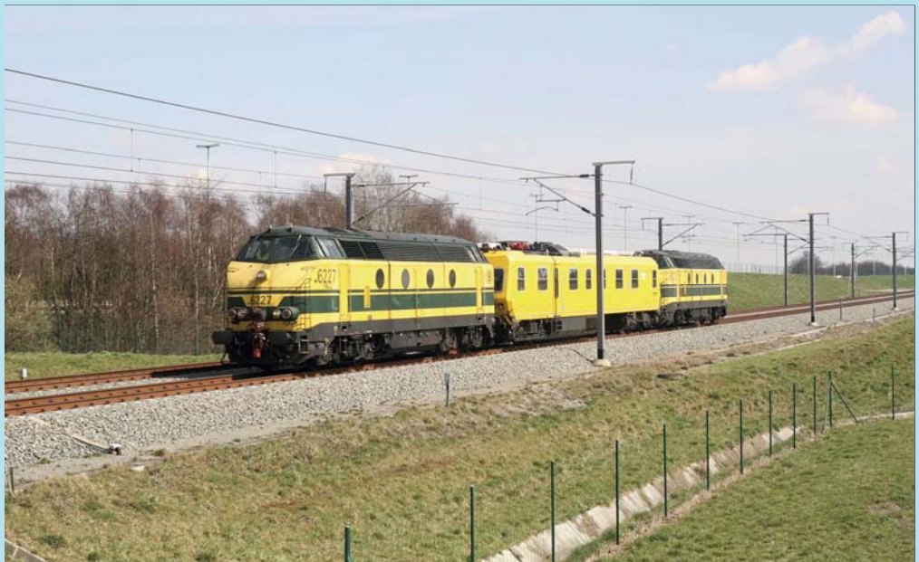
FOTO 100-36 Zes locomotieven van de reeks 55 werden omgebouwd voor het slepen van werktreinen op L1. Voor L2 werden 4 locomotieven van de reeks 62/63 aangepast. De meetmotorwagen EM130 wordt nabij Berloz (L2) ingesloten door de 6227 en de 6225. Michel HANSSENS.
