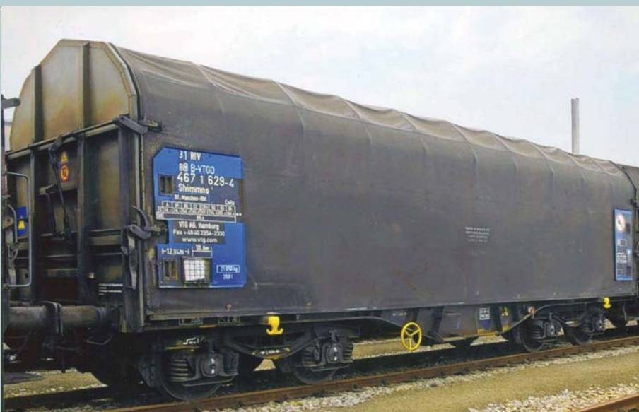
De Fas-wagens van het type 1415G5 waren de eerste die werden herschilderd in 'appel'groen of 'B-Cargogroen' als gevolg van hun verbouwing in 1998. Hier een wagon na zijn transformatie, daartegenover de wagens van het type 1415A2 die wachten op hun ombouw naar 1415G5 (voor het transport van schroot). CW Gentbrugge. Foto GOOSSENAERTS, verzameling Charles OCSINBERG.
