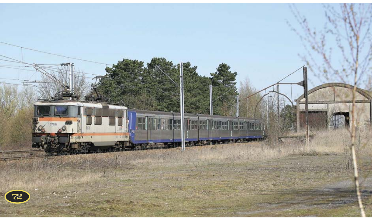
Een TER-dienst met een afwijkende machine: de 16786 die, samen met de 16785, is uitgerust met multiplexing voor het opdrukken van treinen van 3600 ton, gesleept door twee locomotieven in treinschakeling, op de Noordoost-as. Gilbert LAURENT.
