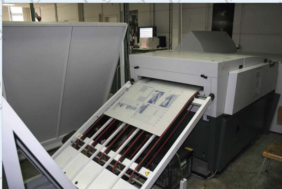
De drukplaten worden gerealiseerd door twee Heidelberg Computer-to-Plate-installaties. Hier verlaat de cyaan-plaat (blauw) de machine.
