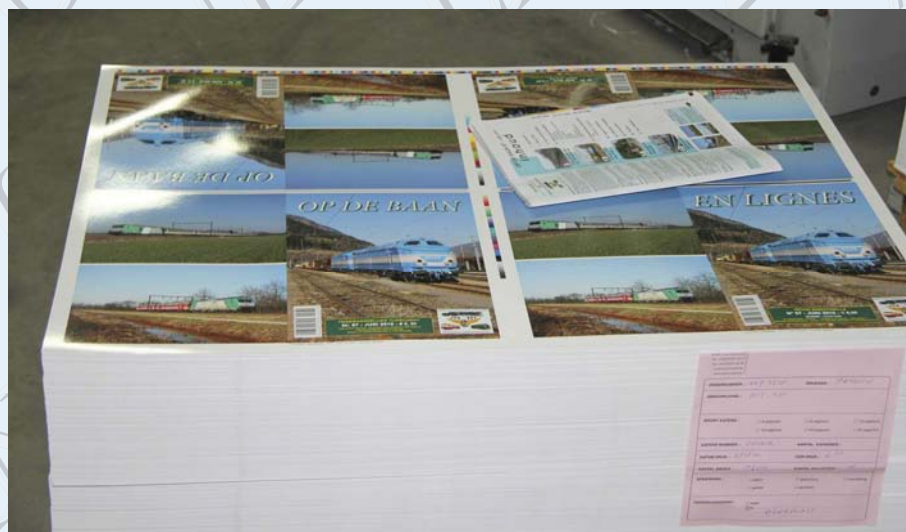
De kافتen zijn klaar. Zij worden eveneens op bladen A1-papier gedrukt maar tellen slechts vier pagina's: de kافتen voor OP DE BAAN en voor EN LIGNES (recto) en de pagina's 2 en 67 (verso) die dubbel worden afgedrukt. Deze A1-bladen worden eerst vertikaal en daarna horizontaal gesneden, en vormen een katern van slechts vier pagina's. De pagina's 1 en 68 krijgen bovendien een extra vernislaag.
