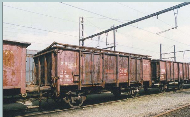
Twee wagens type 1212G2. Links de 21 88 502 9 2189-9; rechts de 21 88 502 9 205-8 die is uitgerust met een nokstang en die zal omgevormd worden als 1212G3 of 1202A1. Deze twee voertuigen staan uitgeweken in Haine-Saint-Pierre om eventueel tentoongesteld te worden in het toekomstig spoorwegmuseum. Charles OCSINBERG.
