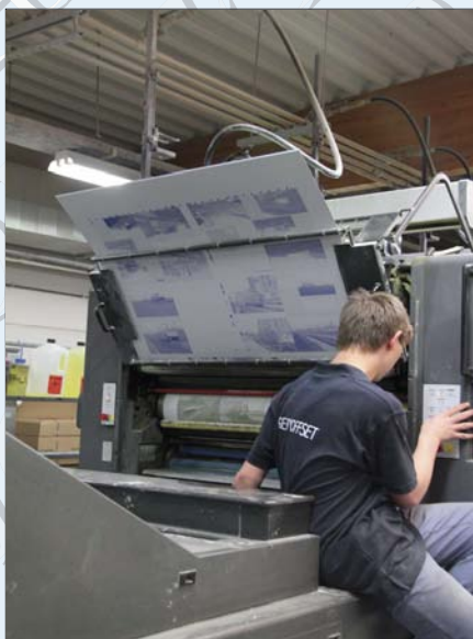
Plaatsing van een plaat in de pers.
