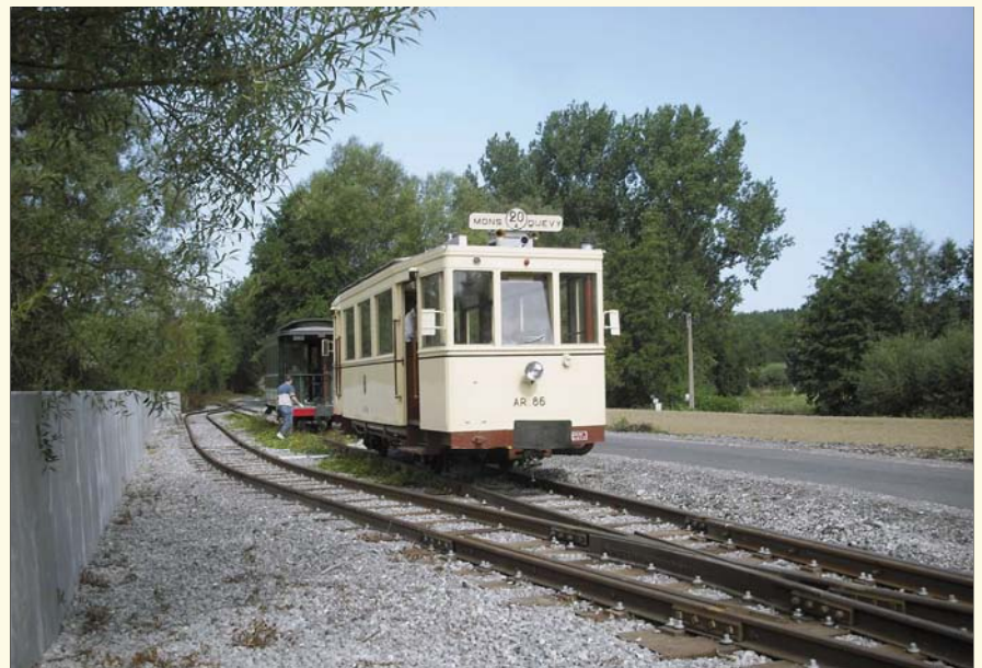
AR 86 aan het wijkspoor te Biesme-sous-Thuin, de nieuwe terminus van de toeristische lijn die wordt uitgebaut door ASVi. Een omloopspoor werd aangelegd om rangeringen te kunnen uitvoeren. 14 augustus 2010, Bernard SCORIEL.
