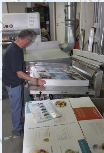
Voor het versnijden gaan de bladen door een trilmachine waardoor zij een perfect blok vormen en alle bladen op dezelfde plaats worden doorgesneden.
