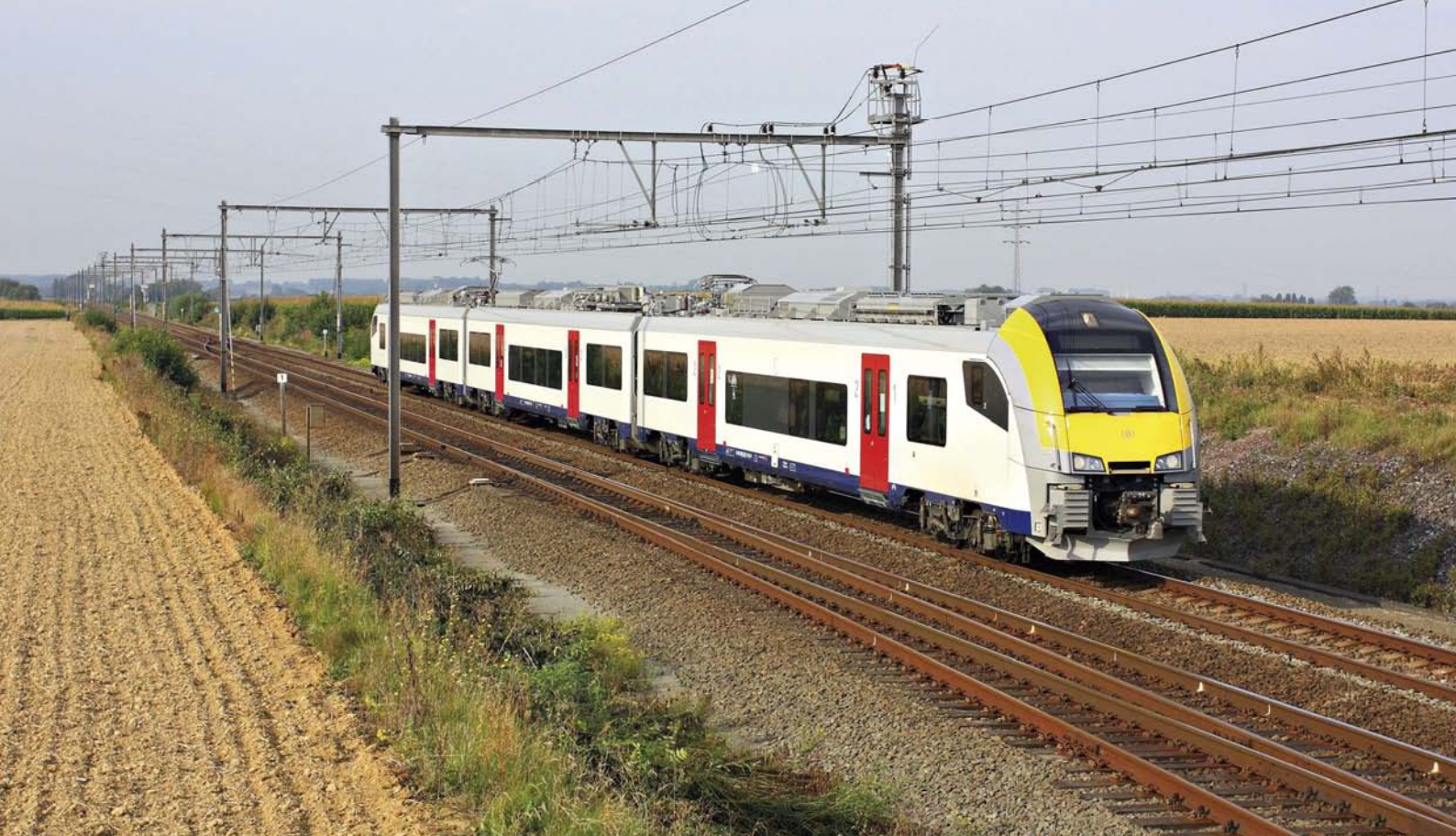
FOTO 100-11 De Desiro 08502 tijdens de homologatieproeven van de reeks. Van 13 tot 17 september werd zij getest onder 25 kV tussen Bertrix en Virton voor de controle van de stroomafname met een aangepaste pantograaf voor 25 kV. Van 23 tot 25 september onderging het stel de electromagnetische compatibiliteitstesten onder 3kV in Bois du Coucou tussen Silly en Ath. Bois du Coucou, 24 september 2010. Christian AUQUIERE.
