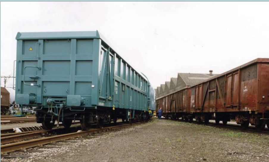
De Fas-wagens van het type 1415G5 waren de eerste die werden herschilderd in 'appel'groen of 'B-Cargogroen' als gevolg van hun verbouwing in 1998. Hier een wagon na zijn transformatie, daartegenover de wagens van het type 1415A2 die wachten op hun ombouw naar 1415G5 (voor het transport van schroot). CW Gentbrugge. Foto GOOSSENAERTS, verzameling Charles OCSINBERG.
