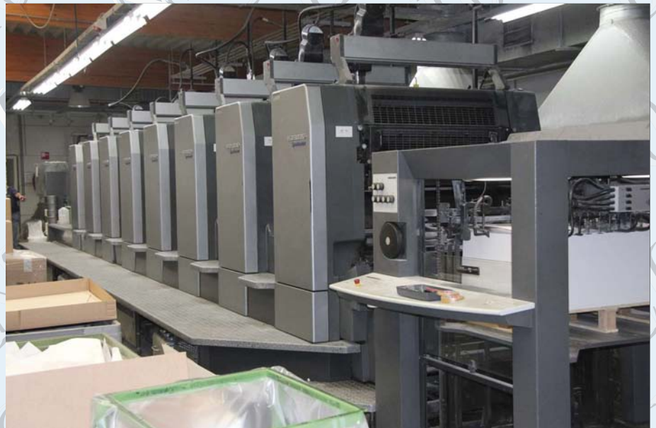
Boven: de Heidelberg-pers waarop OP DE BAAN 97 wordt gedrukt. Deze drukeenheid bestaat uit acht achter elkaar geplaatste rotatiepersen. In elke pers wordt een drukplaat aangebracht. Rechts de lader met papier. Onder: De magenta-drukplaat draait in de rotatiepersen.
