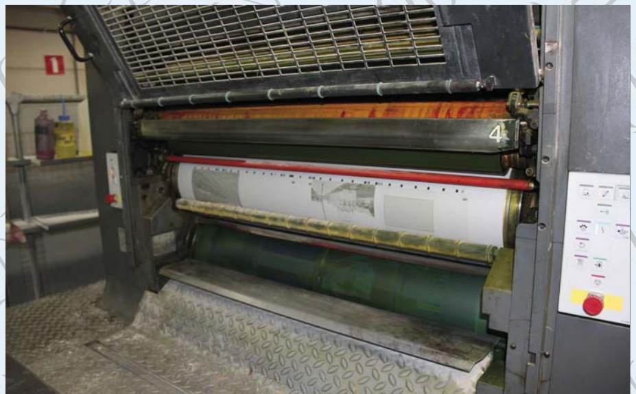
Boven: de Heidelberg-pers waarop OP DE BAAN 97 wordt gedrukt. Deze drukeenheid bestaat uit acht achter elkaar geplaatste rotatiepersen. In elke pers wordt een drukplaat aangebracht. Rechts de lader met papier. Onder: De magenta-drukplaat draait in de rotatiepersen.
