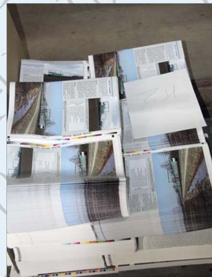
Na het drukken worden de katernen geplooid voor verdere afwerking.
