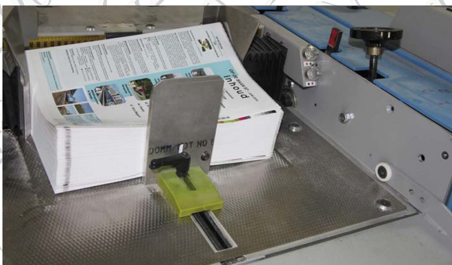
Een voorraad katernen, hier de pagina's 3 t/m 10 en 59 t/m 66, in een van de laders van de assemblagemachine.
