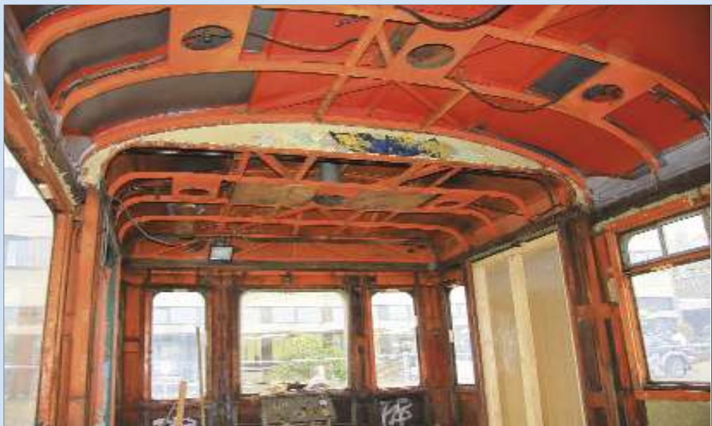
Twee foto's van de renovatie van de 551.26 door de studenten van de technische school TIO in Overpelt. De zijwanden en het plafond werden opnieuw geïsoleerd. TSP / Freddy DELARBRE.
