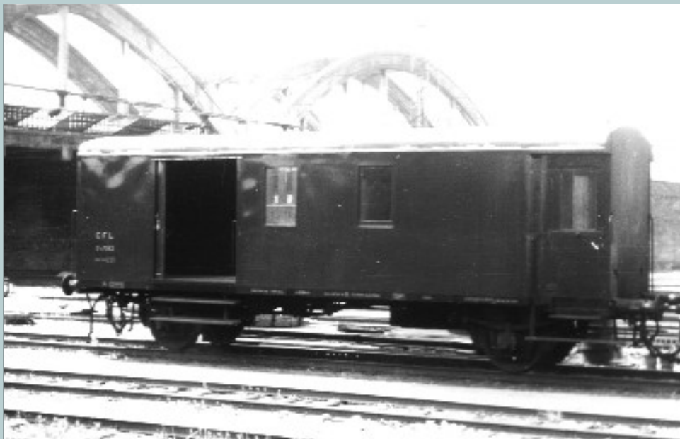
Pakwagen D2m 7062 van de CFL. Het gaat om de vroegere 124.819 van de DR die oorspronkelijk in Oostenrijk werd ingezet. De foto werd gemaakt in Luxemburg in 1962. Foto J.ZEUG, Verzameling Jean-Pierre STEFFEN.
