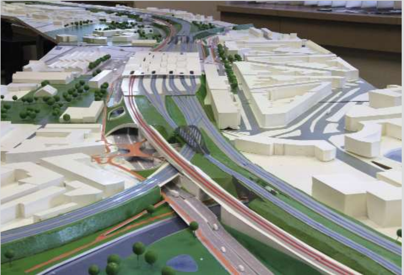
De maquette gezien in de richting Brussel. In het rood zien we de twee nieuw aan te leggen snelle sporen die, kijkend richting Brussel, links van lijn 25 voorzien zijn. In het midden zien we de huidige Vierendeelbrug die lijn 25 over de lijnen 53 naar Leuven en 53A naar Muizen leidt. We zien hier ook de nieuwe ringlaan die parallel met de nieuwe sporen over de terreinen van de Centrale Werkplaats zal aangelegd worden. Copyright TUC RAIL.
