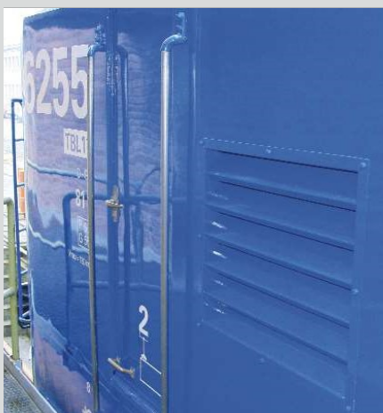
Een ventilatierooster voor de elektrische groep werd aangebracht rechts van de deur van stuurcabine 2.
