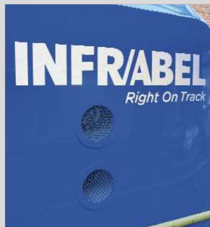
Op de rechterflanken van beide stuurcabines werden er twee kleine roostertjes aangebracht voor de aircogroep.
