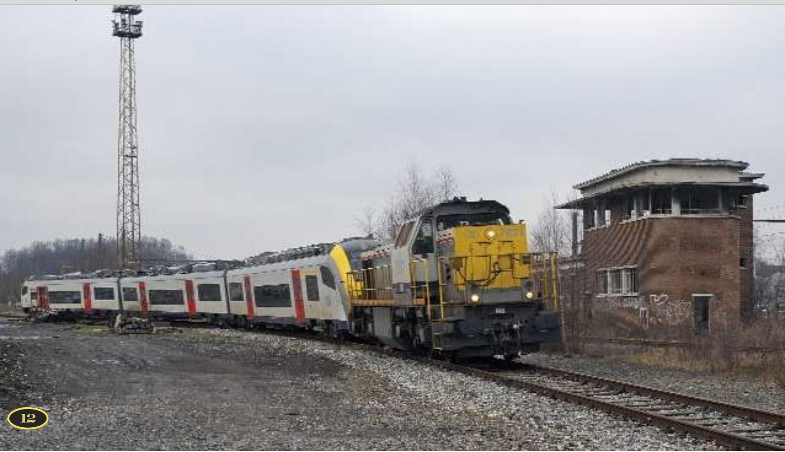
↓ Op 21 januari werd de 08501 onder extreme omstandigheden getest: in een korte bocht en op een steile helling aan de oude werkplaats van Haine-St.-Pierre. Dominique ALLARD.
