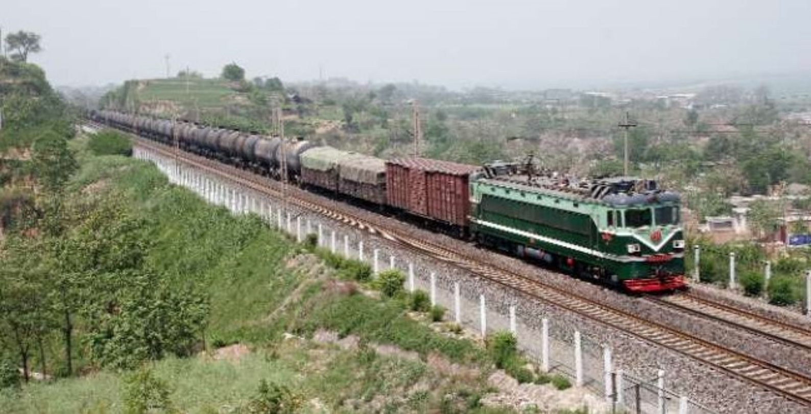
FOTO 107-78 Deze foto werd genomen op 21 april 2006 langs de Long Hai-lijn, te Weinan ter hoogte van km 1027, niet ver van Xian. Aan kop van de trein: de SS1-0730. De SS1'en waren de eerste elektrische locomotieven die in China gebouwd werden, in totaal 826 eenheden van 1957 tot 1988 door de fabriek van Zhuzhou. Met een massa van 138 ton en een vermogen tussen 3900 en 4200 kW, haalden zij een snelheid van 90 km/h. Jean-Luc VANDERHAEGEN.
