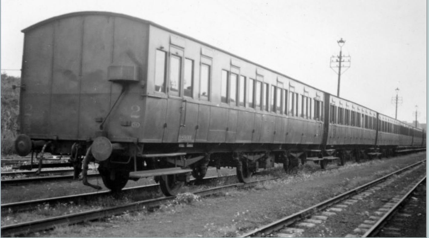
De rijtuigstam "T" bestaande uit de rijtuigen 89.001 + 89.002 + 89.003 (ex-6201 + 4801 + 4802). Enkel de toegangsdeuren aan de uiteinden van de rijtuigen zijn niet verwijderd. Schaarbeek, augustus 1951. Foto DESBARAX.
