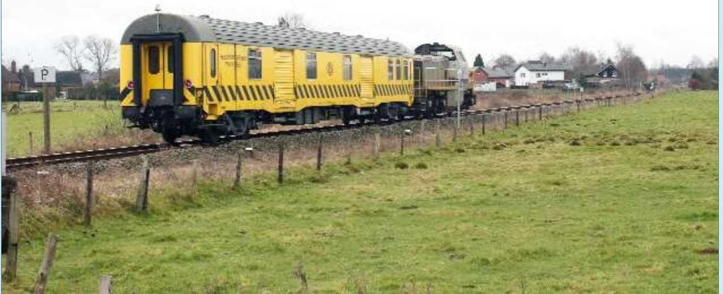
FOTO 107-53 ↑ Hersporingsrijtuig 00057 (60 88 99-29 057-4) van Hasselt ontstond uit de ombouw van Dms-pakwagen 17.416 (afgewerkt te Oostende op 5 juli 1999). Doortocht te Schaffen (L 17 Tessen-derlo - Diest), gesleept door de 7852 op 20 januari 2006. Peter VAN GESTEL..
