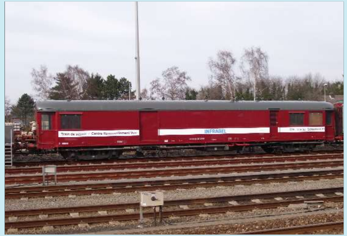
↑ Rijtuig 00218 (60 88 99-29 218-1) ontstond uit de ombouw van I1-rijtuig nr. 12.017 in 1979. Sinds de ingebruikname op 21 januari 1980 doet het dienst als werkplaats. Opmerkelijk is het feit dat deze voertuigen geen rijtuignummer hebben gekregen maar wel een wagennummer. Sinds begin 1990 worden zij niet meer beschouwd als "rijtuig". Mol, 17 maart 2010. Johnny BRAUNS.
