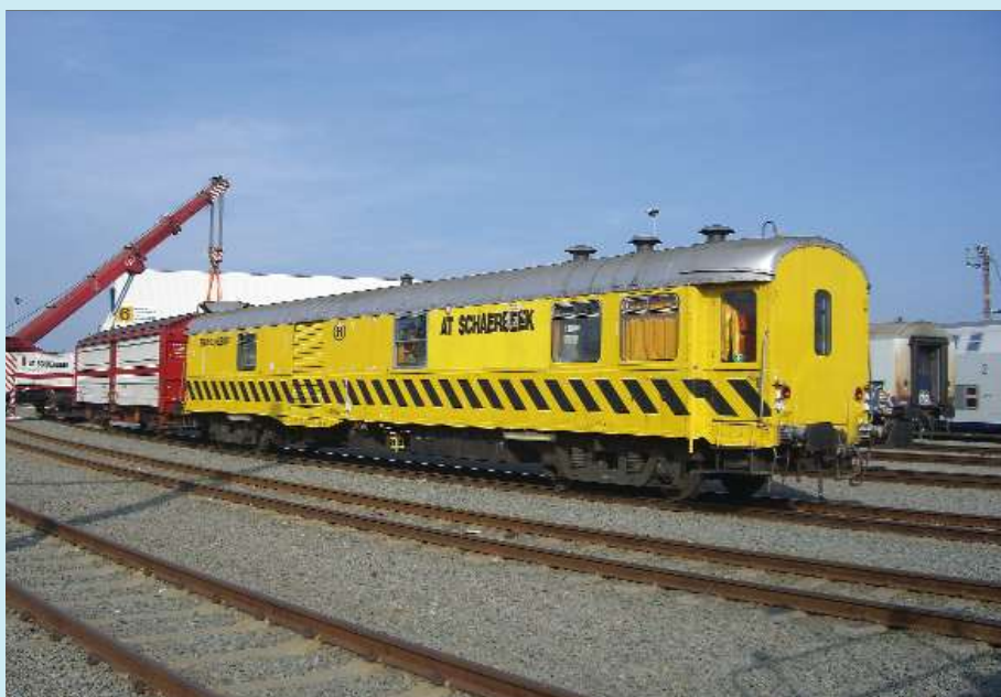
FOTOTHEMA 107 Meetrijtuig 00800 berijdt elk jaar meermaals alle lijnen van het net. Op 22 maart 2011 werd het omkaderd door de 5540 en 5515, om op de niet geëlektrificeerde lijn 17 Diest – Tessenderlo te kunnen rijden. De trein bevatte ook twee 16-rijtuigen, waarvan één nog steeds de "Memling"-livrei droeg. Doortocht te Zichem. Simon DE RIDDER.
