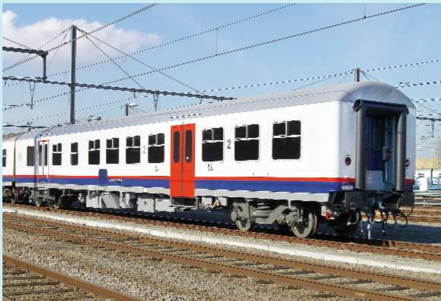
FOTO 107-20 Met 573 eenheden zijn de M4-rijtuigen het best vertegenwoordigd in het NMBS-park. Hier zien we de 59.930 (50 88 87-78 030-4), één van de 35 BD-rijtuigen (2de klasse met bagageafdeling). Schaarbeek, 7 april 2008. Jean-Luc VANDERHAEGEN.
