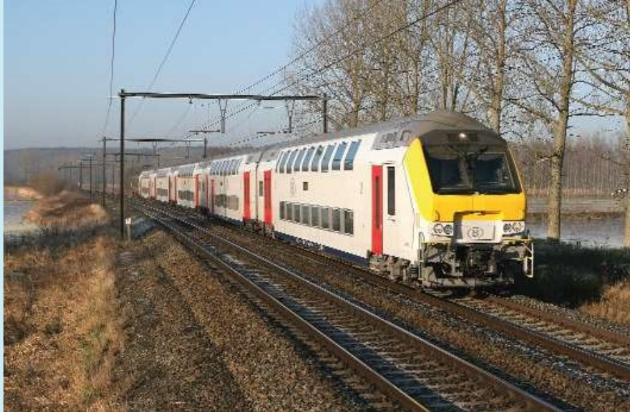
FOTO 107-26 ↑ De IC-E 1508 Knokke / Blankenberge - Tongeren wordt uitzonderlijk met slechts één M6-trek-duwstam gereden. Vooraan bevindt zich het stuurstandrijtuig Bx 69.002 (50 88 80-72 002-6), één van de 41 Bx-rijtuigen die met een automatische GF-koppeling is uitgerust. Zichem, 19 december 2007. Luc VANDERHAEGEN.
