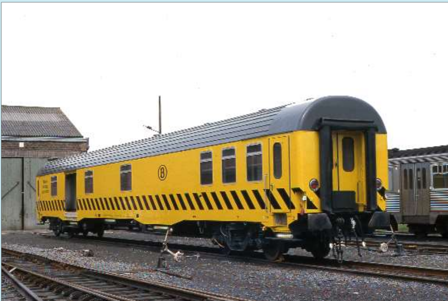
FOTO 107-53 ↑ Hersporingsrijtuig 00057 (60 88 99-29 057-4) van Hasselt ontstond uit de ombouw van Dms-pakwagen 17.416 (afgewerkt te Oostende op 5 juli 1999). Doortocht te Schaffen (L 17 Tessen-derlo - Diest), gesleept door de 7852 op 20 januari 2006. Peter VAN GESTEL..
