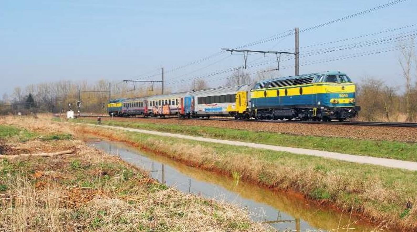
FOTOTHEMA 107 Meetrijtuig 00800 berijdt elk jaar meermaals alle lijnen van het net. Op 22 maart 2011 werd het omkaderd door de 5540 en 5515, om op de niet geëlektrificeerde lijn 17 Diest – Tessenderlo te kunnen rijden. De trein bevatte ook twee 16-rijtuigen, waarvan één nog steeds de "Memling"-livrei droeg. Doortocht te Zichem. Simon DE RIDDER.
