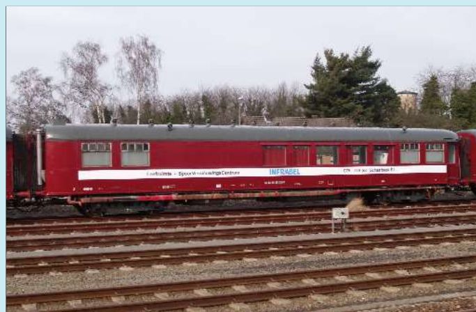
↑ Rijtuig 00216 (60 88 99-29 216-3) ontstond uit de ombouw van I1-rijtuig nr. 12.018 in 1979 (voltooid op 1 januari 1980). Het dient als keuken en eetplaats. Mol, 17 maart 2010. Johny BRAUNS.
