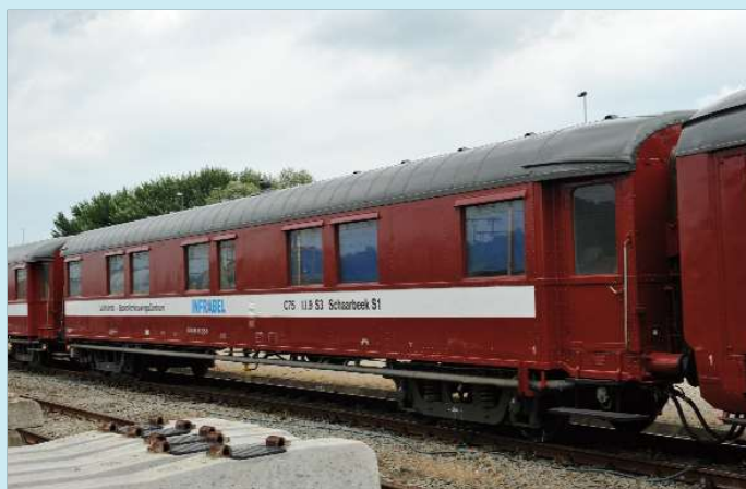
↑ Rijtuig 00215 (60 88 99-29 215-5) ontstond uit de ombouw van I1-rijtuig nr. 12.019 in 1979 (voltooid op 1 januari 1980). Het wordt gebruikt als slaaprijtuig. Vilvoorde, 25 juli 2010. Lucien CLAEYS.
