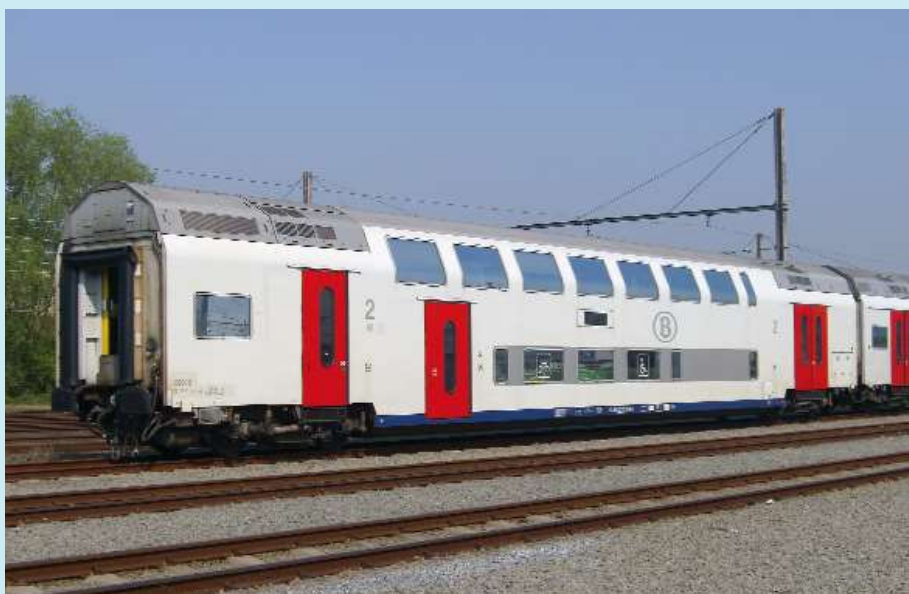
FOTO 107-26 ↑ De IC-E 1508 Knokke / Blankenberge - Tongeren wordt uitzonderlijk met slechts één M6-trek-duwstam gereden. Vooraan bevindt zich het stuurstandrijtuig Bx 69.002 (50 88 80-72 002-6), één van de 41 Bx-rijtuigen die met een automatische GF-koppeling is uitgerust. Zichem, 19 december 2007. Luc VANDERHAEGEN.
