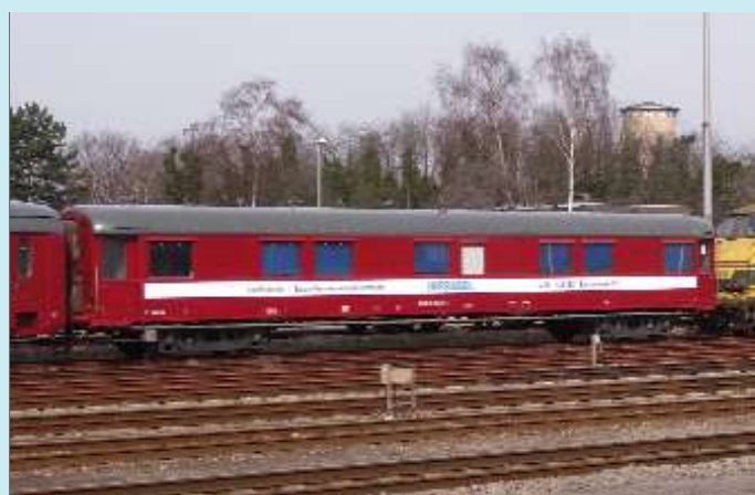
↑ Rijtuig 00214 (60 88 99-29 214-8) ontstond uit de ombouw van I1-rijtuig 12.016 in 1979 (voltooid op 1 januari 1980). Het is ingericht als slaaprijtuig. Mol, 17 maart 2010. Johny BRAUNS.
