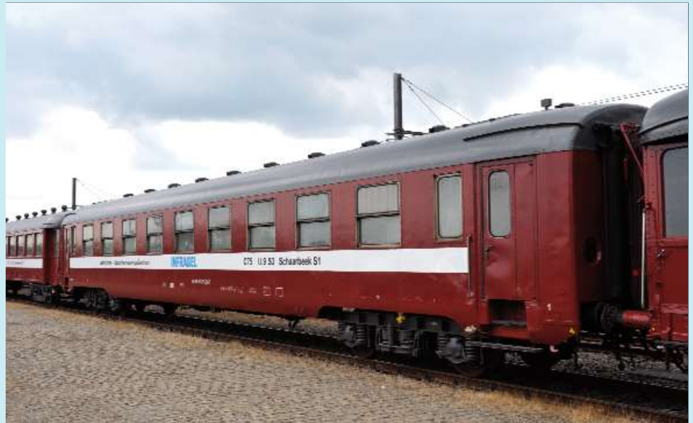
↑ Rijtuig 00218 (60 88 99-29 218-1) ontstond uit de ombouw van I1-rijtuig nr. 12.017 in 1979. Sinds de ingebruikname op 21 januari 1980 doet het dienst als werkplaats. Opmerkelijk is het feit dat deze voertuigen geen rijtuignummer hebben gekregen maar wel een wagennummer. Sinds begin 1990 worden zij niet meer beschouwd als "rijtuig". Mol, 17 maart 2010. Johnny BRAUNS.
