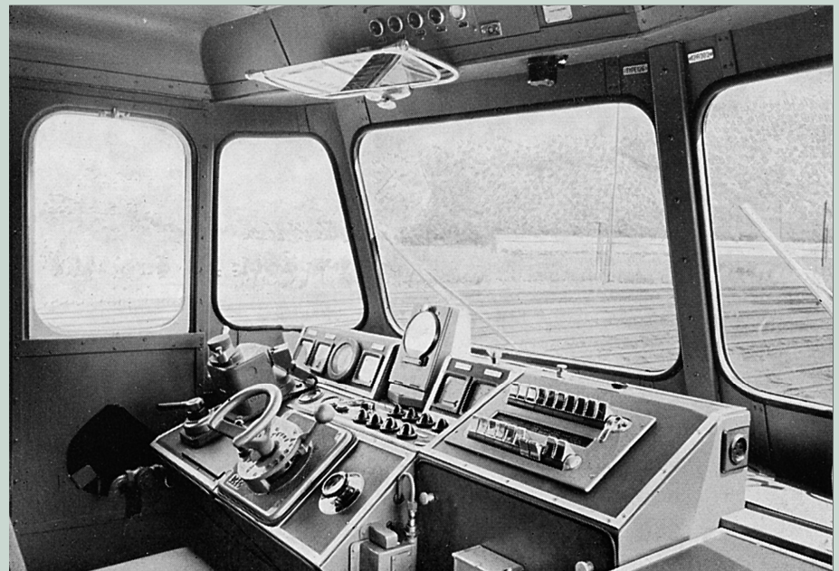
De stuurposten van de types 122 t.e.m. 125 en 140 (latere reeksen 22, 23, 24, 25 en 25.5) waren redelijk klein en de apparaten zoals bv. de rechtstreekse remkraan, waren niet altijd even logisch opgesteld. De stuurposten van het type 126 vormden als het ware een echte revolutie. Ze waren ruim, helder verlicht, alle apparaten bevonden zich op hun ideale positie. Bovendien was hun verwarming zeer efficiënt. Zelfs bij extreme vrieskou kreeg men het behaaglijk warmgestookt, hetgeen bij de oudere types niet altijd het geval was. Deze foto toont de stuurtafel van een 126 prototype, te herkennen aan het tractiewiel identiek aan deze van de types 122 t/m 125 en 140.
