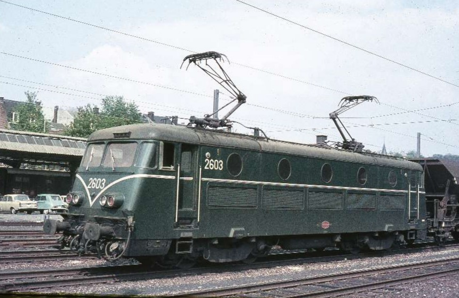
FOTOTHEMA 109 De 2603 in het station van Namur. We merken op dat de bladveren van de secundaire ophanging reeds verwijderd zijn. Ze is nog niet uitgerust met kabels voor het rijden in treinschakeling. Foto Julien CASIER, verzameling TSP.
