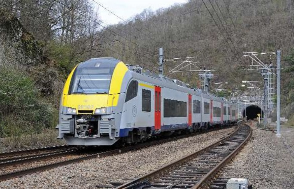
Het Desiro-motorstel 08502 komt op 17 april 2012 aan te Houyet. Tijdens deze testrit werd het thermisch gedrag van de 25 kV-uitrusting gecontroleerd, specifiek de temperatuur van de transformator. Dominique ALLARD.
