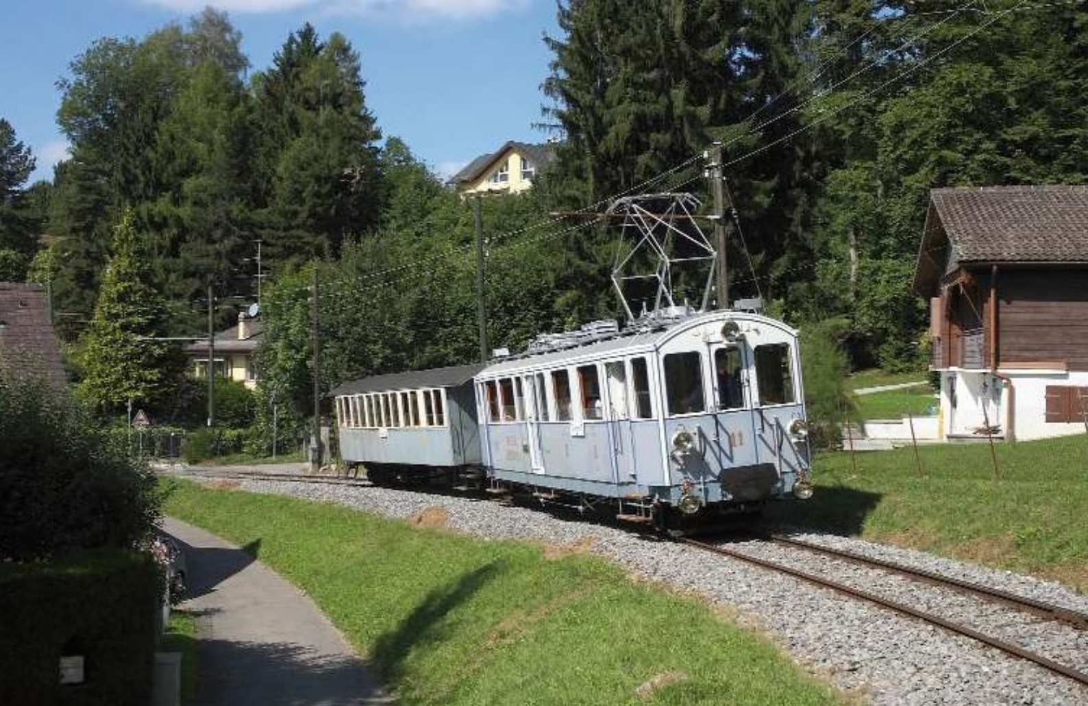
FOTO 112-54 De prachtige motorwagen ABDe 4/4 11 van de MOB te Chantemerle, tussen Blonay en Chamby op 15 september. Deze werd in 1911 in dienst genomen, kan rijden aan 50 km/h, heeft een vermogen van 250 kW en weegt 29 ton. Michel HANSSENS.
