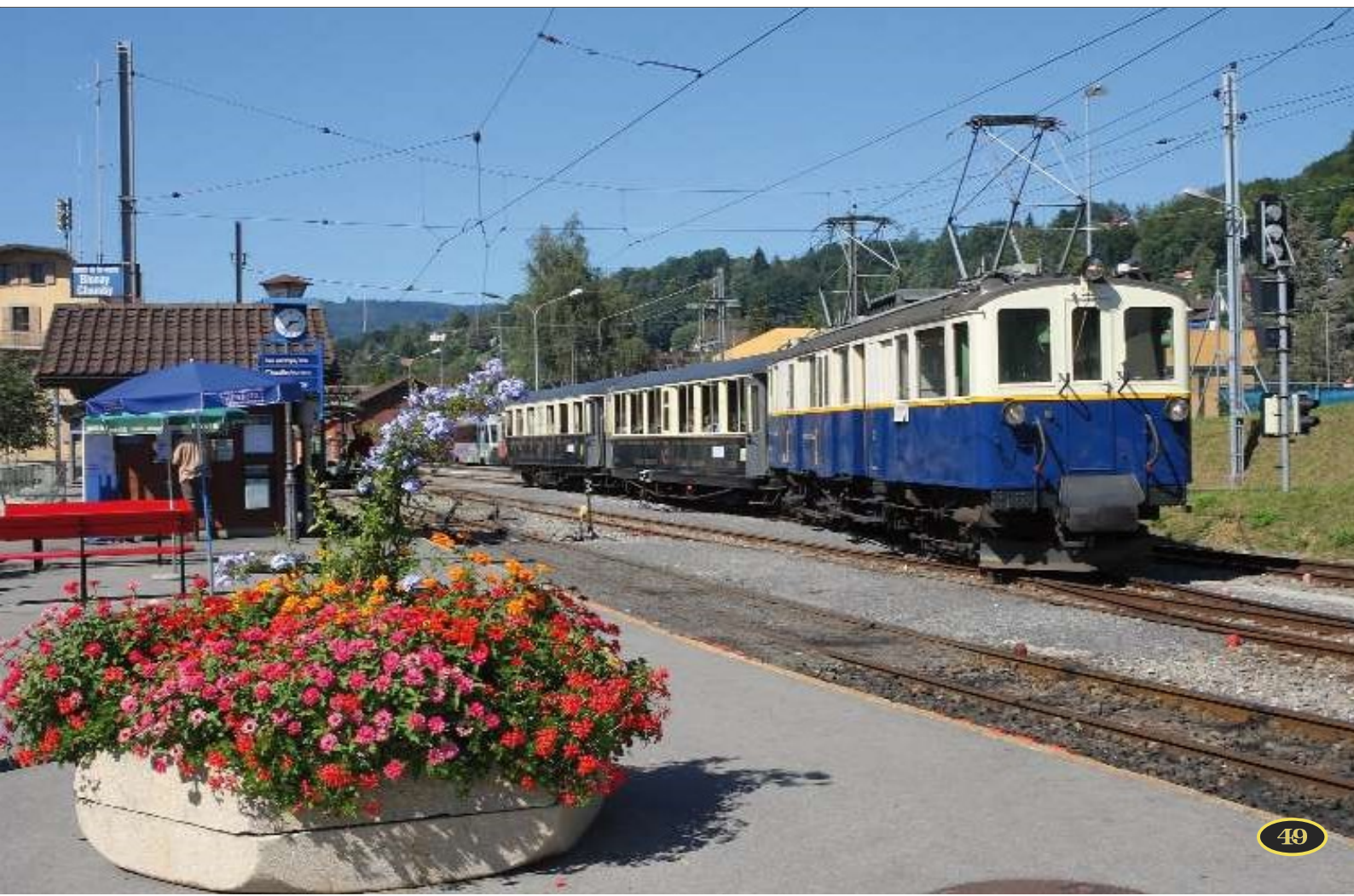
FOTO 112-55 Op 16 september is de MOB-motorwagen BDe 4/4 28 samen met twee historische Pullman-rijtuigen net aangekomen uit Vevey en wacht te Blonay op het vertrek naar Chamby. Deze motorwagen werd in dienst genomen gelijktijdig met de BDe 4/4 27 in 1924. Het vermogen is 388 kW, de maximum snelheid 50 km/h en het totaal gewicht 36,2 t. Michel HANSSENS.
