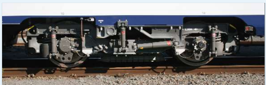
De loop- en motordraaistellen zijn nagenoeg gelijk. Hier een loopdraaistel dat tussen de wielen onderaan is uitgerust met elektromagneetremmen.
