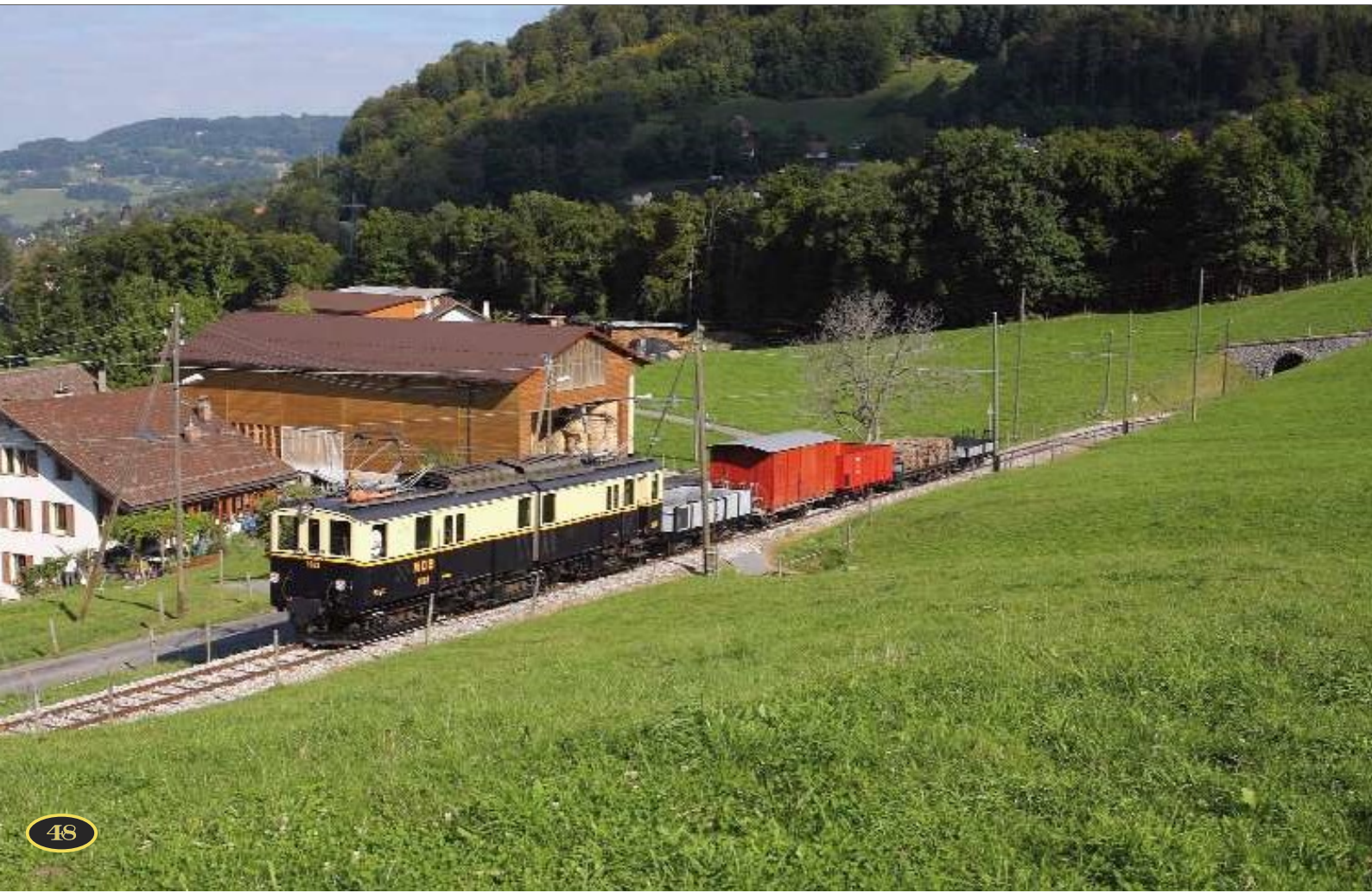
FOTO 112-53 De gelede MOB-motorwagen DZe 6/6 2002 sleept een korte goederentrein tussen Chamby en Blonay. De motorwagens van dit type (2001-2002) werden in 1932/33 in dienst genomen. De twee kasten rusten op drie draaistellen. Vermogen 737 kW, maximale snelheid 60 km/h, totaal gewicht 62,8 t. Cornaux, 15 september. Michel Hanssens.
