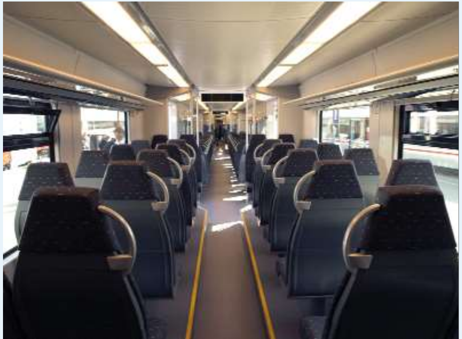
Binnenzicht vanuit het B-rijtuig. We bemerken de afwezigheid van intercircuitatiedeuren wat een totaalbeeld van het hele motorstel levert. Lionel GOTA.
