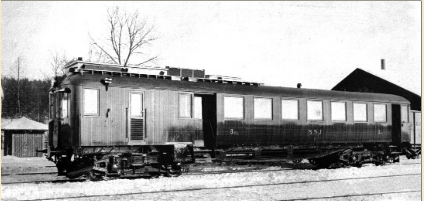
Een diesel-elektrische motorwagen van 120 pk die in 1928 door ASEA gebouwd werd voor de private maatschappij Stockholm - Nynäs Järnväg (SNJ). De in 1932 geleverde 650.01 van de NMBS leek sterk op dit voertuig. De draaistellen zijn identiek. Foto SJ.
