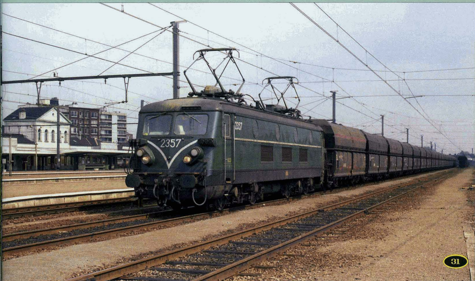
FOTO 116-80 ↓ Op 21 april 1987 staat een kolentrein uitgeweken in Braine-le-Comte. Op de 2357 werd de verchromde V vervangen door een witte geschilderde. Roestvorming, welke invrat op de plaats waar de treinschakelingskabels werden aangebracht, was hier de oorzaak van. In totaal kregen 33 machines een geschilderde V: 2302, 2303, 2304, 2311, 2312, 2314, 2320, 2324, 2325, 2329, 2331, 2334, 2335, 2338, 2339, 2342, 2343, 2346, 2347, 2348, 2352, 2353, 2354, 2357, 2358, 2360, 2364, 2365, 2366, 2368, 2369, 2370 en 2371. Jean-Luc VANDERHAEGEN.
