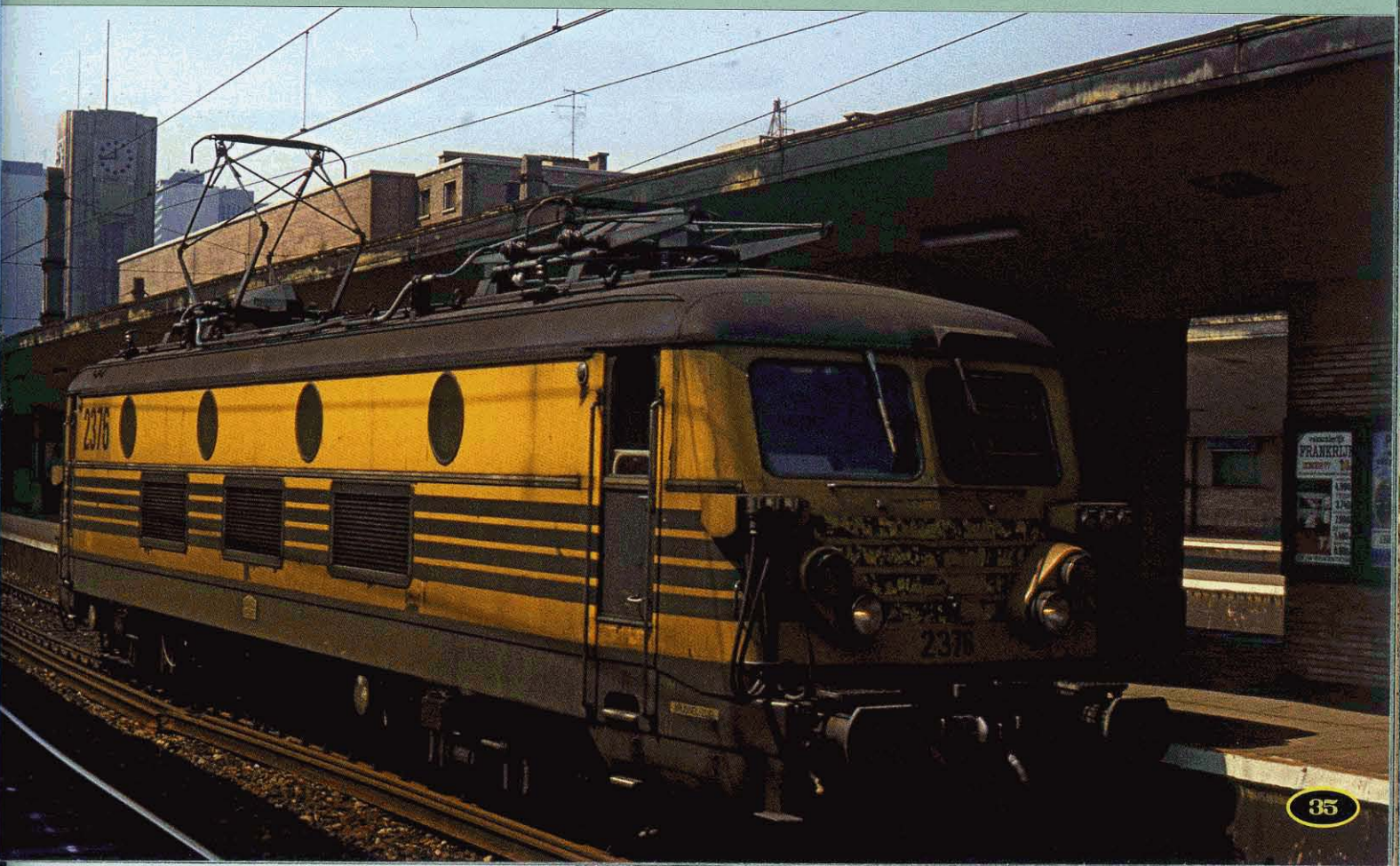
FOTO 116-85 ↓ De groene banden werden met zelfklevende tape uitgevoerd. Op 1 juni 1978 reed de 2376 de Centrale Werkplaats van Mechelen binnen voor een algemene revisie en verliet deze op 28 juli 1978 herschilderd in de nieuwe gele kleur. Voor ze de CW binnenreed, was ze al niet meer om aan te zien. De groene zelfklevers op de kopwand zijn haast volledig verdwenen. Foto Julien CASIER, verzameling TSP.
