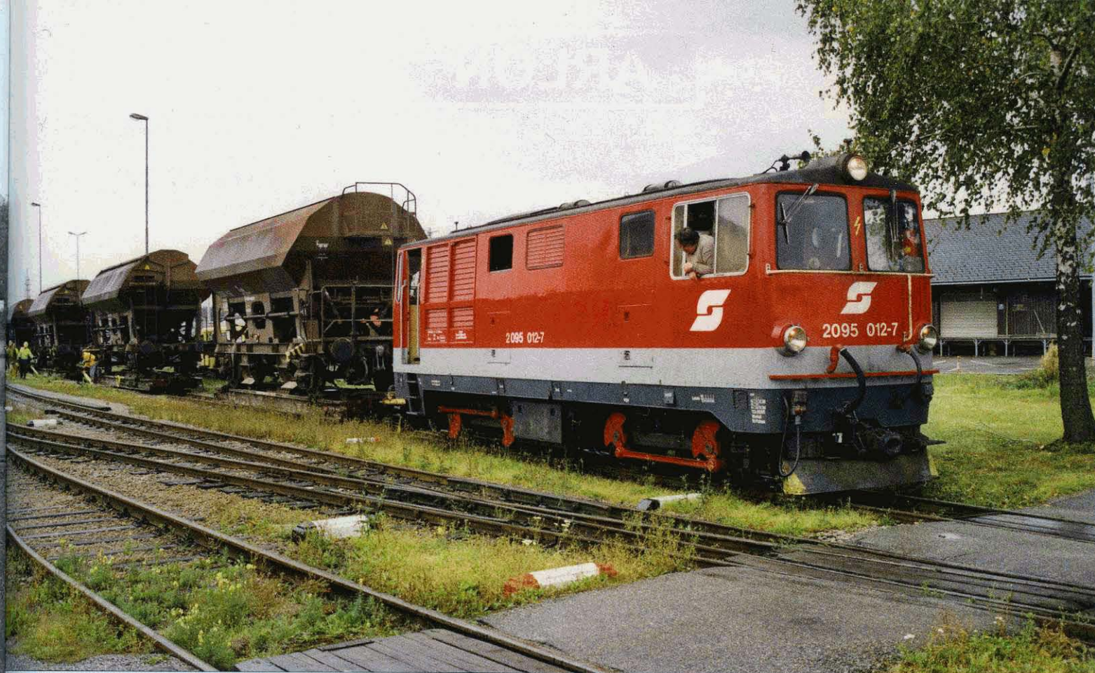
FOTO 117-83 ↑ Op 15 september 2004 rangeert de 2095 012 van de ÖBB een rolwagentrein in het station van Gmünd. Het gaat hier om een diensttrein met steenslag voor het vernieuwen van de ballast. De laatste commerciële goederentrein op dit smalspoornet reed op 8 januari 2000. Van de reeks 2095 werden tussen 1958 en 1962 15 exemplaren geleverd door SGP. Ivo VAN STEENWINKEL.
