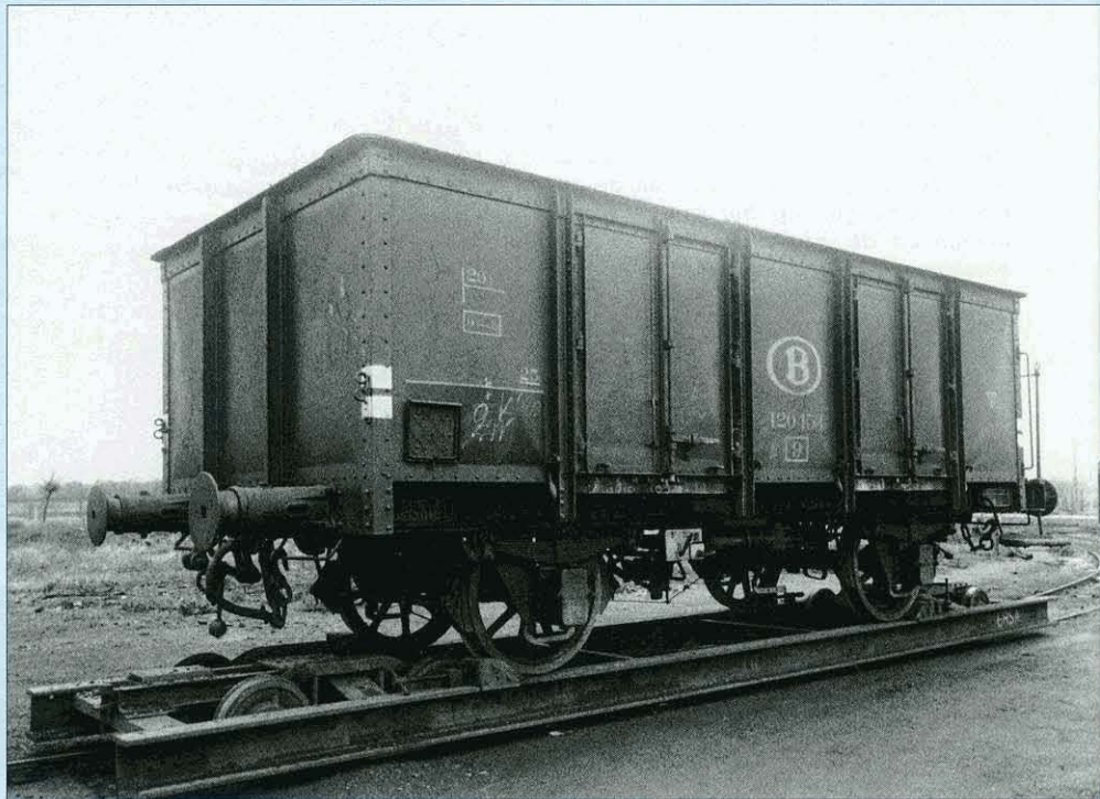
↑ Een stortwagen van de NMBS op een rolwagen van de lijn Warsage - Trembleur. Fotograaf en datum onbekend, verzameling TSP.
