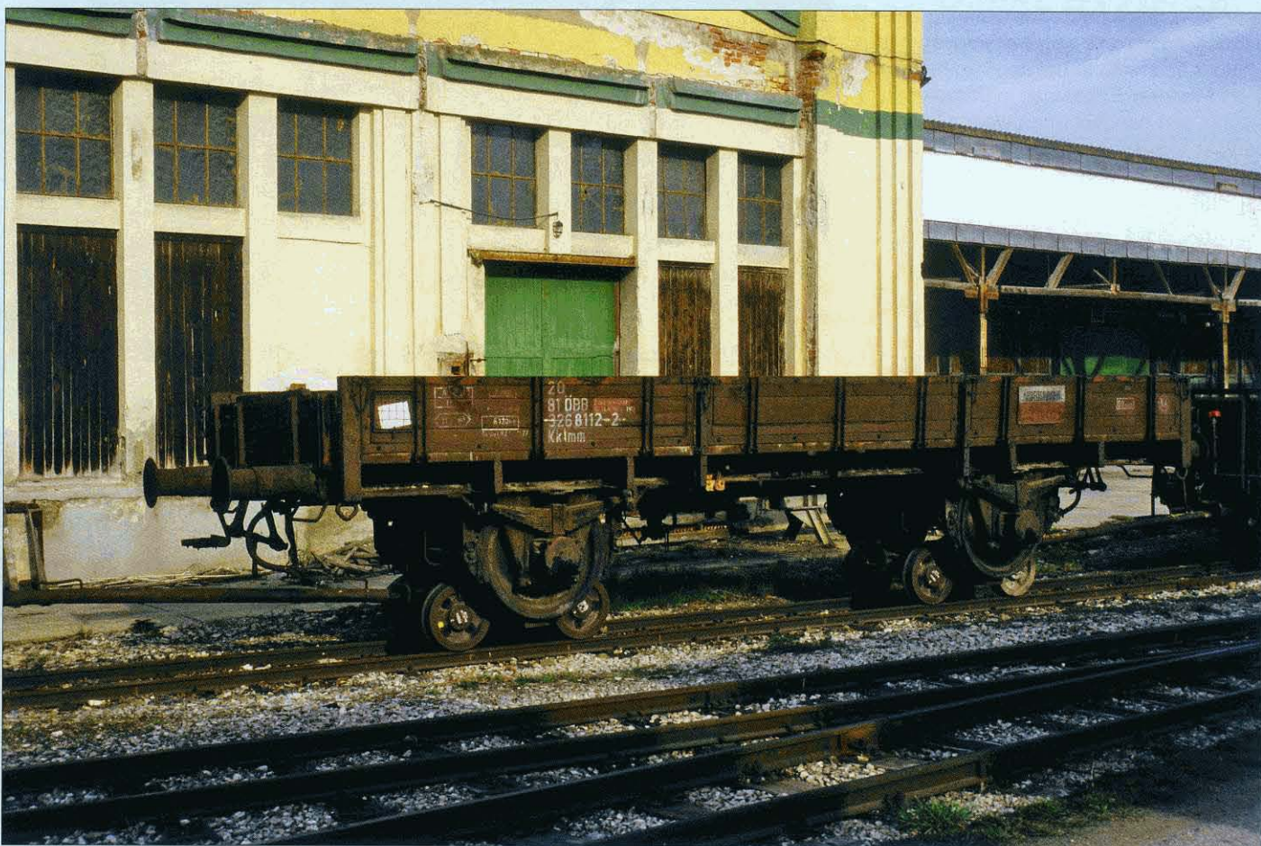
FOTO 117-51 Bij het klassieke rolbokstelsel wordt onder elke as van een normaalspoorwagen een tweessige lorie geplaatst. De Oostenrijkse spoorwegen (ÖBB) gebruikten dit stelsel tot 1987. Een platte wagen die op rolbokken werd geplaatst, maakt sindsdien deel uit van de museumcollectie van de ÖBB. Obergrafendorf, 4 april 1998. Wim DE RIDDER.
