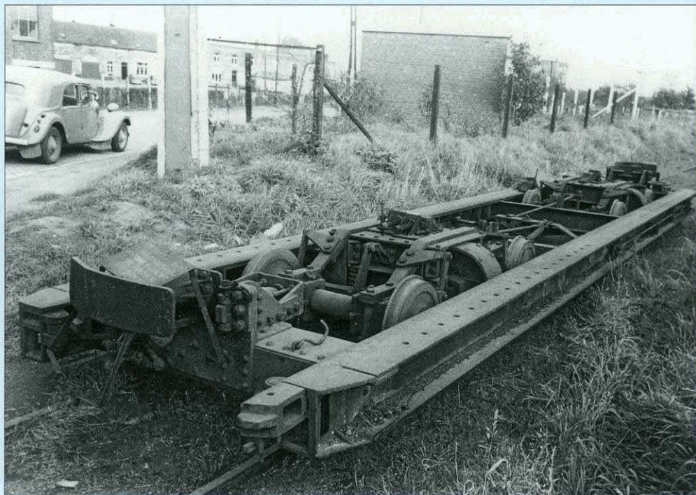
Voor de bediening van de suikerfabriek van Quévy beschikte de NMVB over twee rolwagens. Ze hadden als bijzonderheid dat ze een voor de buurtspoorwegen typische centrale buffer hadden. Eén van beide rolwagens werd in 1957 in Quévy gefotografeerd. Foto G. GAUTHIER; verzameling Lucien LUYCKS.
