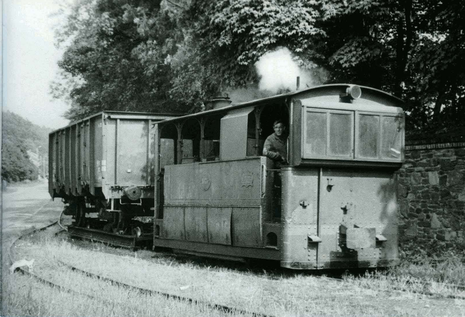
FOTO 117-62 ZW ↑ - FOTO 117-63 ZW ↓ Dalhem, 4 mei 1965. De 1075 sleept een op een rolwagen geplaatste lege stortwagen van Warsage naar de mijn. Foto's J. Benson, verzameling Maurice HENNEQUIN / TSP.
