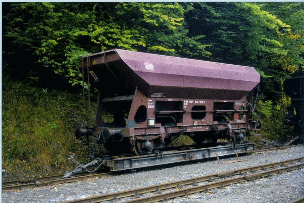
FOTO 117-48 Rolwagens bestaan uit een onderstel met twee stalen balken die dienst doen als railsegment voor de te vervoeren normaalspoorwagens. We zien hier rolwagen 99-20-38 van de Harzer Schmalspurbahnen in Eisfelder Thalmühle op 4 oktober 1997. Wim DE RIDDER.
