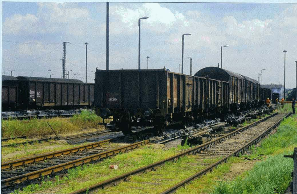
FOTO 117-50 De rolwagenuil van Oschatz (Sachsen) op 7 juli 1991. De in de achtergrond zichtbare smalspoorlocomotief heeft zonet alle rolwagens tegen elkaar gedruwd waardoor deze een doorgaand "spoor" vormen. Nadat de goederenwagens onderling gekoppeld werden, zullen ze door een normaalspoorlocomotief van de rolwagens worden getrokken. Wim DE RIDDER.
