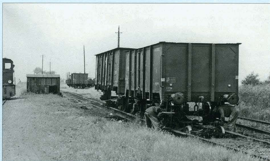
In het station van Warsage worden twee stortwagens op rolwagens geplaatst. De metersporige diesellocomotief heeft de wagens op rolwagens getrokken met behulp van een kabel. De rangeerders plaatsen de wielklemmen. Verzameling TSP.
