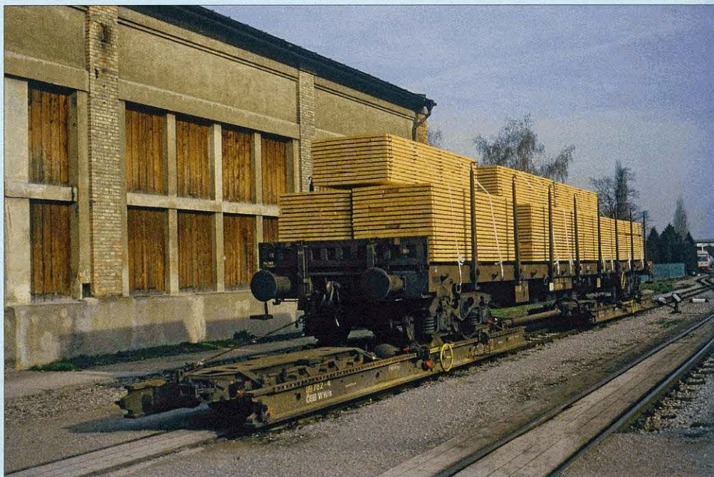
FOTO 117-49 Het transport van wagens op draaistellen is geen probleem. Onder elk draaistel wordt een rolwagen geplaatst, zoals bij deze met hout beladen ÖBB-wagen. Obergrafendorf (Oostenrijk), 4 april 1998. Wim DE RIDDER.
