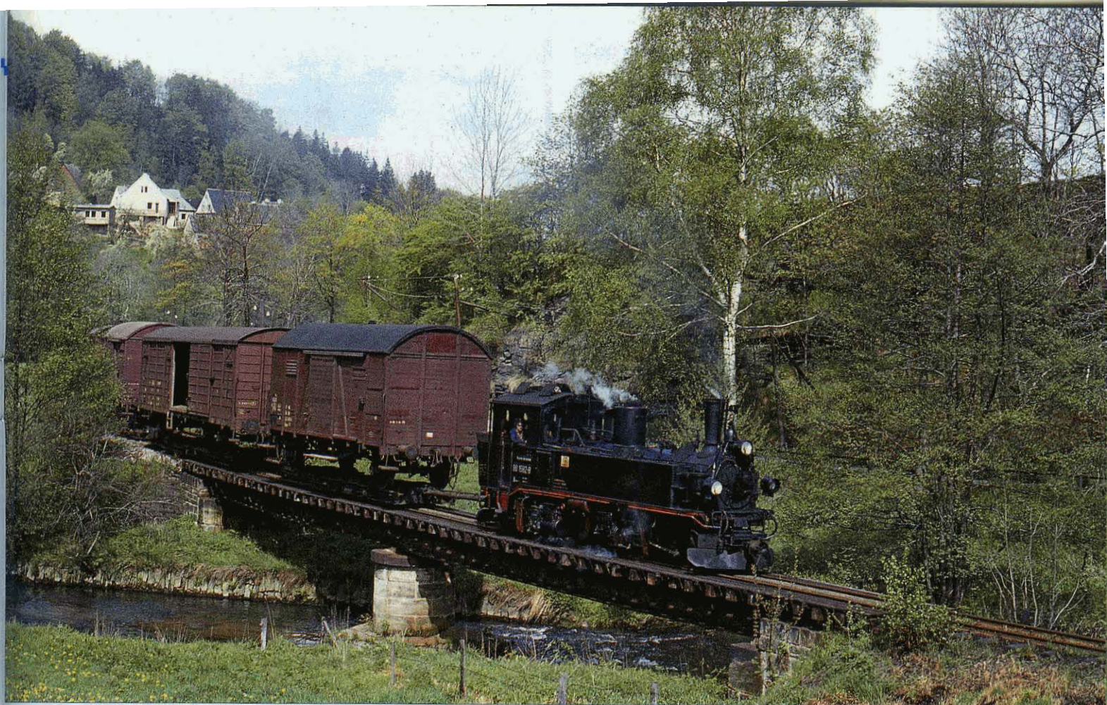
FOTO 117-76 ↑ Op de bekende Pressnitzalbahn (lijn Wolkenstein - Jöhstadt, spoorbreedte 750 mm) werden ook rolwagens ingezet. In de jaren '80 sleept de 99 1582 van de DR een goederentrein bestaande uit gesloten wagens in de buurt van Streckewalde. Deze machines maakten deel uit van de beroemde reeks IV K van de Königlich Sächsische Staatseisenbahnen. Van deze reeks werden 96 eenheden gebouwd door Hartmann tussen 1892 en 1922 (K.Sächs.Sts.E.B. 103 t/m 198, later DRG 99 511 t/m 579, 581 t/m 608, vervolgens DR reeks 99 1500). Pierre HERBIET.
