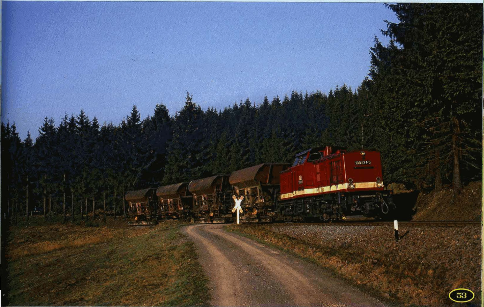
FOTO 117-77 ↓ Voor interne steenslagtransporten beschikt de HSB nog over een aantal rolwagens waarop geschrapte zelfflossers van de DB en de DR werden geplaatst. Op 2 april 1999 sleept de 199 871 bij Sorge een aantal van deze wagens. Wim DE RIDDER.
