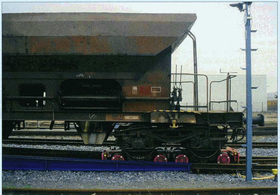
Een foto van rolbok Ua 220 van het type Vevey die ingezet wordt door de Zwitserse maatschappij Bière-Apples-Morges (BAM). De wielen van de normaalspoorwagens rusten in de zichtbare steun. Morges, 11 september 2007. Marc STRIFFELER.
