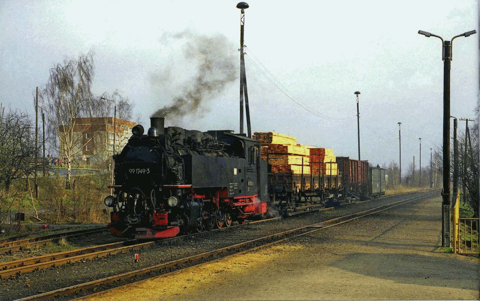
FOTO 117-78 ↑ Op 20 maart 1991 staat een goederentrein met twee op rolwagens geladen normaalspoorwagens in het station van Zittau-Vorstadt (lijn Zittau - Bertsdorf - Oybin/Jonsdorf - spoorbreedte 750 mm). De trein wordt gesleept door de 99 1749 (Schwartzkopff 9638/1929) van de stelplaats Zittau. Deze reeks van 32 1E1't's werd tussen 1928 en 1933 gebouwd door Hartmann en Schwartzkopff (DRG 99 731 t/m 762, later reeks 99 1700 van de DR). Philippe GOUSSET.
