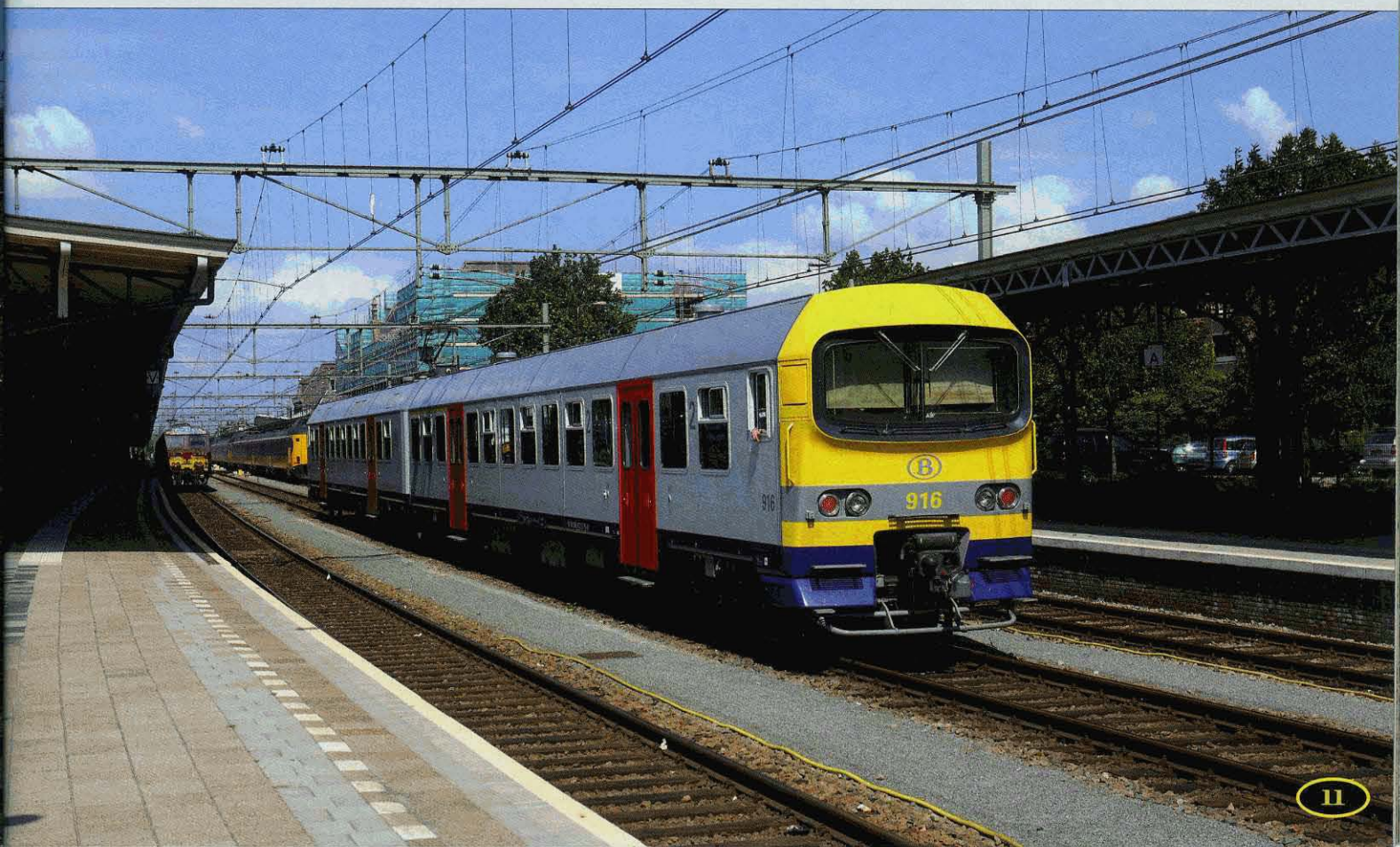
↓ FOTO 117-11 Een tweede motorstel van de reeks 900 verliet de werkplaats na zijn modernisering op 31 mei 2013. Het gaat om de 916, hier gefotografeerd bij aankomst in Roosendaal op 19 juli 2013. Bemerkt de grijze band die toegevoegd werd ter hoogte van de koplampen. Het eerste gemoderniseerde motorstel, de 917, had deze band niet. Deze verbleef in de loop van de maand mei in de werkplaats van Schaarbeek. Jean-Luc VANDERHAEGEN.
