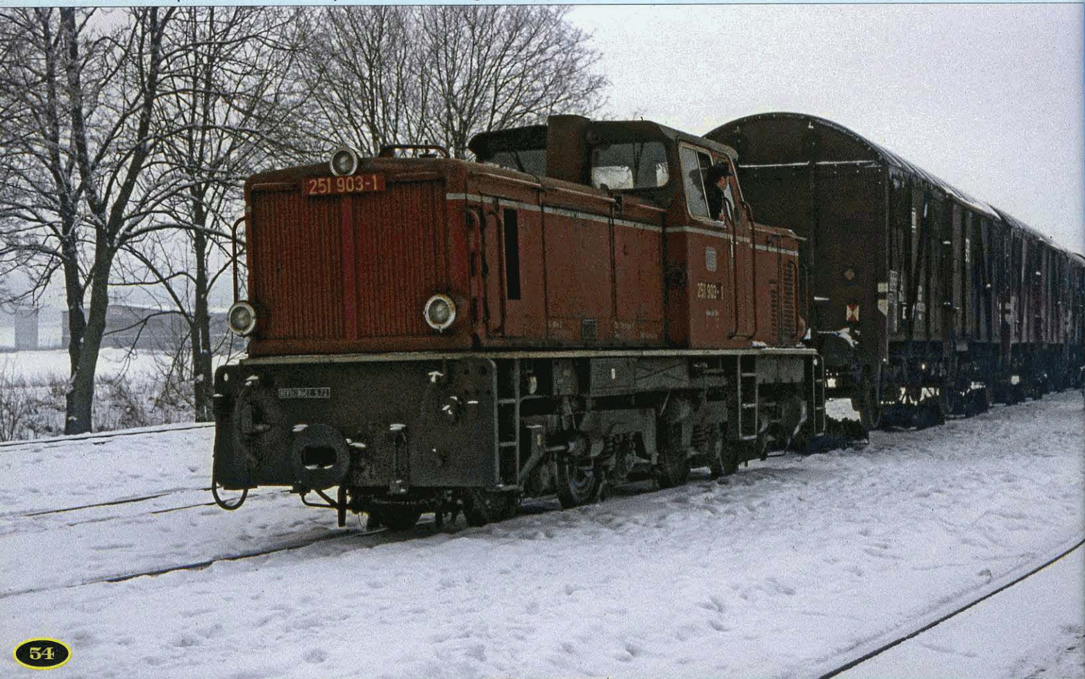
FOTO 117-79 ↓ Bij haar oprichting in 1949 erfde de DB verschillende smalspoorlijnen. In 1964 werden vijf bij Gmeinder gebouwde diesellokomotieven in dienst gesteld: de V51 901 t/m 903 (750 mm) en de V52 901 en 902 (1000 mm). In 1968 werden ze ingedeeld in de reeksen 251 en 252. In 1972 rangeert de 251 903 in het station van Warthausen (op de lijn Warthausen - Oschenhausen) met een trein bestaande uit op rolbokken geplaatste gesloten wagens. De reeks 252 werd geschrapt op 5 juni 1973; de reeks 251 op 29 december 1983 (de 251 901 werd al op 21 februari 1971 geschrapt). Foto Julien CASIER, verzameling TSP.
