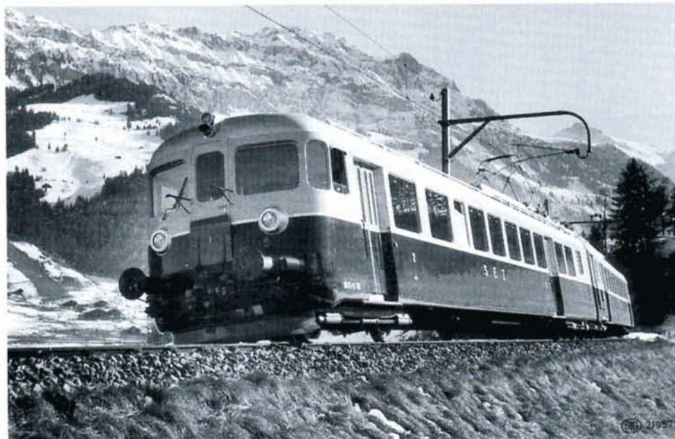
schleiss an Rad und Schiene positiv zu beeinflussen. Ausführungsbeispiele hierfür sind die noch in Betrieb stehenden BLS-Doppeltriebwagen ABDe 4/8 741 – 743 (heute 744 – 745 der BLS-Gruppe und 243 der Oensingen – Balsthal-Bahn) der Baujahr 1945/46.
