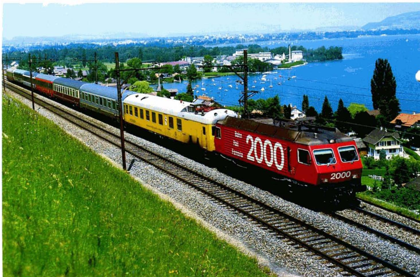
(entsprechend einer unausgeglichenen Querbesehleunigung von 0,8 m/s<sup>2</sup> auf Gleisebene). Für den Versuchszug war die Höchstgeschwindigkeit durch die Spurführungskräfte der Lokomotive vorgegeben und betrug 85 km/h (entsprechend 1,15 m/s<sup>2</sup>).
