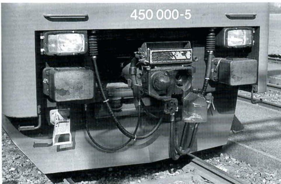
Links unten: Die automatische Kupplung an der Führerraumseite von Lokomotive und Steuerwagen. Der Schutzdeckel über den elektrischen Kontakten ist zu Demonstrationszwecken geöffnet (Foto D. Heer).
