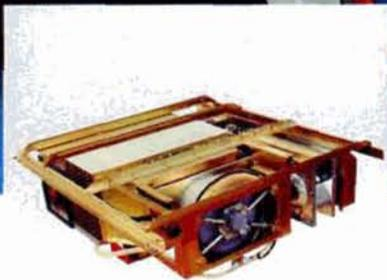
*Dachraum-Luftaufbereitungsaggregat zur Klimatisierung von InterCity-Reisezugwagen Typ EWIV der Schweizerischen Bundesbahnen mit Gebläse für Luftaustritt durch Bodenkanal (Warmluft) sowie Deckenkanal (erwärmte oder gekühlte Luft).*
