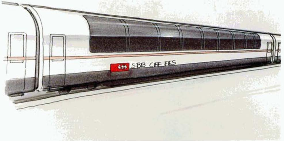
Die Scheiben wurden speziell für den Panoramawagen entwickelt. Jede Scheibe ist 140 kg schwer. Sie besteht aus metalloxydbeschichteten, gut isolierenden Sicherheitsverbundgläsern und wird direkt in einen Rahmen eingeklebt. Die Fabrikation der Scheiben erfordert grösste Sorgfalt, damit später nicht durch Eigenspannungen Risse in den Gläsern auftreten.
